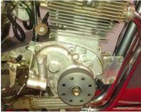
**Lichtmaschine / elektronische Zündung für MV Agusta 350 with Dansi Magneto**
