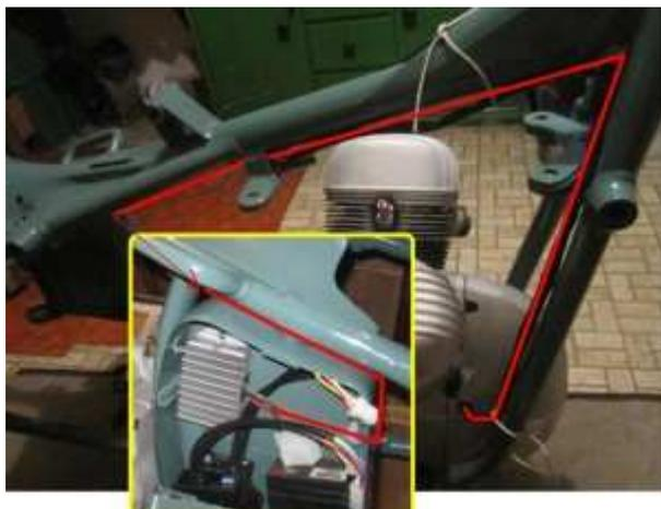
Befestigen Sie den neuen elektronischen Gleichrichter/Regler an einer geeigneten Stelle. Das kann z.B. auch in einem [leeren Batteriegehäuse](#) sein, weil die Anlage auch [ohne Batterie fahren](#) kann. Das kann bei der Victoria auch der Werkzeugkasten sein und die Teile könnten durchaus auch unter dem Tank im Tunnel angebracht werden können.
