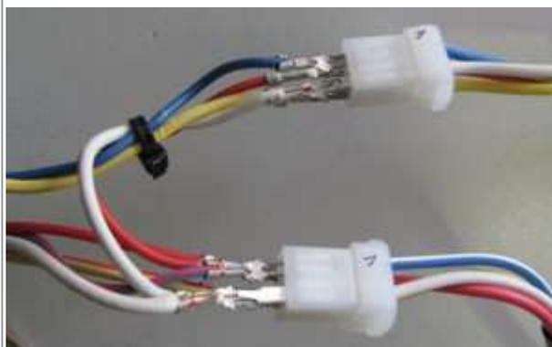
Nehmen Sie die weiblichen Stecker der beiden Steuereinheiten und verbinden Sie diese wie folgt mit dem Kabelbaum:
