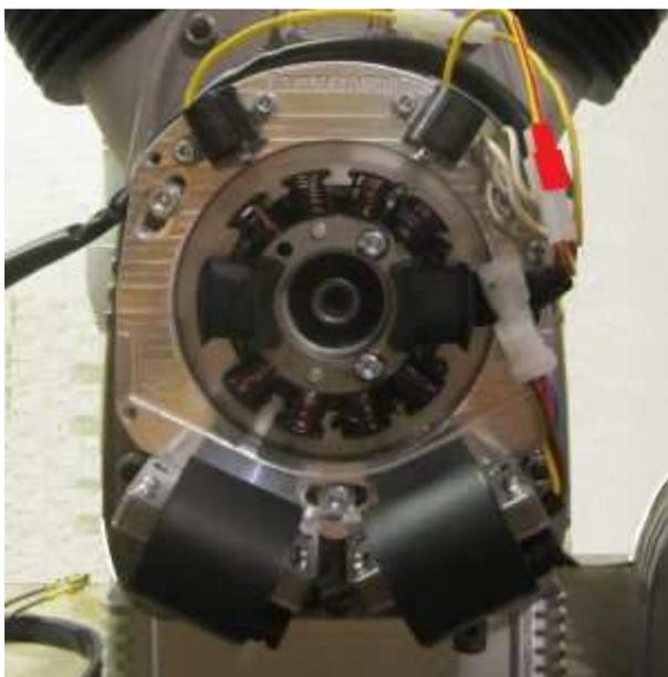
Setzen Sie die vormontierte Statorplatte auf den Motor. Verschrauben Sie sie mit den 3 mitgelieferten M6x20 Schrauben und Unterlegscheiben.
