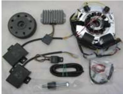
Ersetzt die [originale Zündlichtmaschine](#), rüstet auf 12V/100W und kontaktlose elektronische Zündung auf. Der Zündzeitpunkt wird mit einer digitalen Steuereinheit verstellt. Das System ist in der Lage [ohne Batterie](#) auszukommen.
