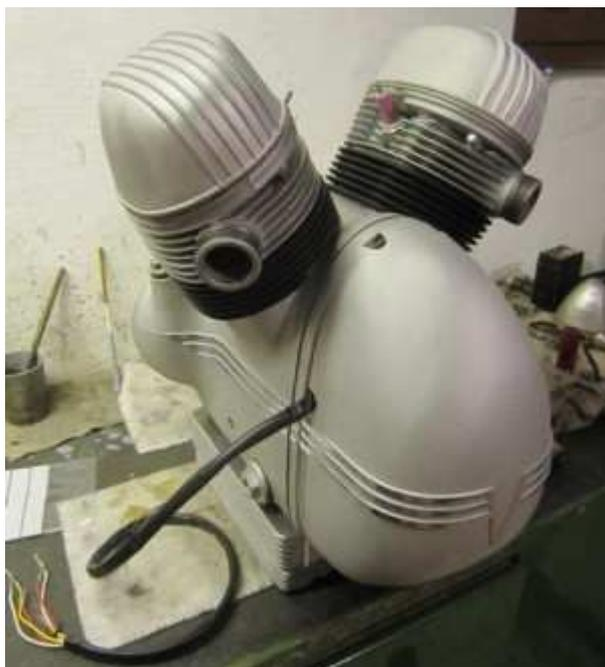
Zum Schluss die Anbringung der originalen Abdeckung. Das Kabel muss durch den vorhandenen Kabelausgang an der Seite geführt werden. Die Zündkabel können aus dem oberen Ausgang geführt werden.
