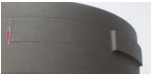
Bringen Sie auf dem neuen Rotor eine Markierung an, die sich 41mm links von dem erhabenen Zeichen befindet. Schneiden Sie dazu bitte einen **41mm** langen Papierstreifen, legen diesen links am Zeichen an und markieren dessen Ende mit einem Strich (Faserstift). Sie haben damit die korrekte Markierung.
