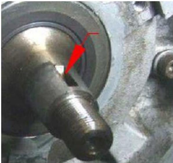
Entfernen Sie die Passfeder vom Lichtmaschinenstumpf. Keine Angst, die hatte keine Halte-, sondern eine Führungsfunktion. Wenn Sie die Passfeder nicht entfernen, können Sie den neuen Rotor später nicht installieren.
