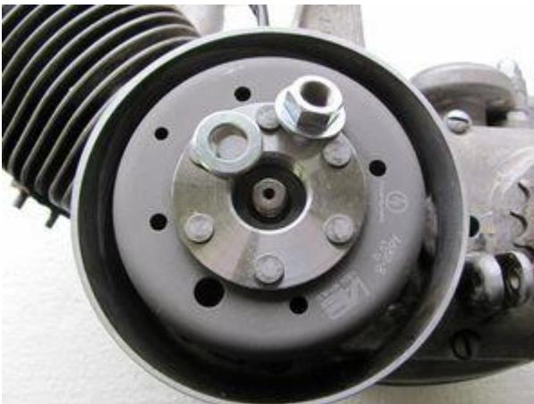
Setzen Sie den Rotor mit der Hand auf die Kurbelwelle (aber nicht fest anziehen), so können Sie den Motor mit dem Rotor drehen und in die Zündposition bringen. Nehmen Sie die Zündkerze heraus, damit der Motor sich leichter drehen lässt.
