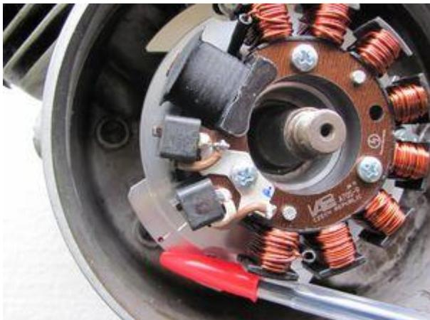
Sehen Sie sich die Statorplatte an. Sie werden dort, etwas links von den beiden kleinen schwarzen Spulen eine Markierung finden.
