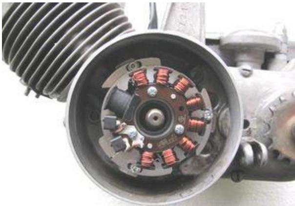
Setzen Sie die vormontierte Statoreinheit auf den Motor und verschrauben Sie diese dort mit den 3 Schrauben M5 unter Beilegen der U-Scheiben.
