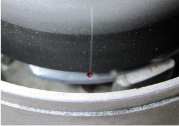
Sehen Sie sich den Rotor a. Auf seinem Umfang werden Sie eine aufgelaserte Linie sehen. Auch das ist eine Zündmarkierung.
