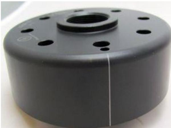
Schauen Sie sich ihren neuen Rotor an, auf seinem Außenumfang befindet sich eine gelaserte Linie. Das ist eine Zünderstellungsmarkierung. Diese ist dauerhaft, aber eingebaut nicht immer gut zu sehen. Ein Nachziehen mit Faserstift ist daher eine gute Idee.
