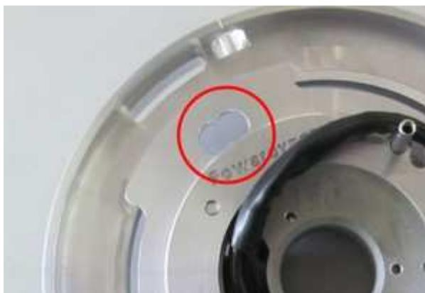
Jetzt wird die vormontierte Statorplatte auf den Motor gesetzt. Dabei muss das Loch zur Zündeneinstellung (siehe Bild) ebenfalls in Richtung des Schraubenloches oben links zeigen.
