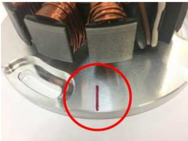
Sehen Sie sich die Grundplatte des neuen Stators an. Auf dem Umfang ist eine rote Markierung aufgebracht (siehe roter Kreis). Das ist eine Zündmarkierung, die beim Einstellen benötigt wird.
