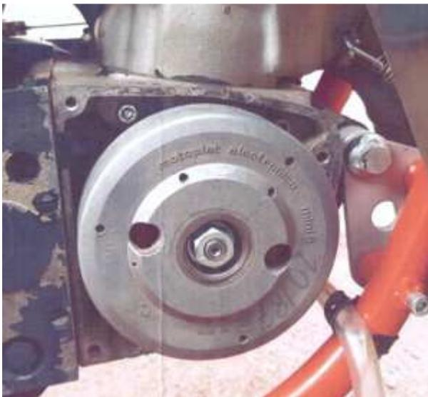
Entfernen Sie alle Kabel und bauen Sie die komplette Motoplat Anlage aus.
