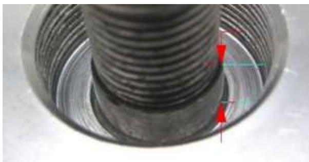
Weiterhin müssen Sie prüfen, ob das Gewinde am Konusende ausreicht, den Rotor mit der Mutter fest anzuziehen. Bei einigen Wellen kann es sein, dass der konische Teil der Welle etwas in die Öffnung für die Schraube reicht (siehe Bild links). Dann besteht die Gefahr, dass der Rotor durch die Rotormutter nicht ausreichend fest angezogen werden kann. Dadurch kann der Rotor verrutschen und der Zündzeitpunkt stimmt nicht mehr.
