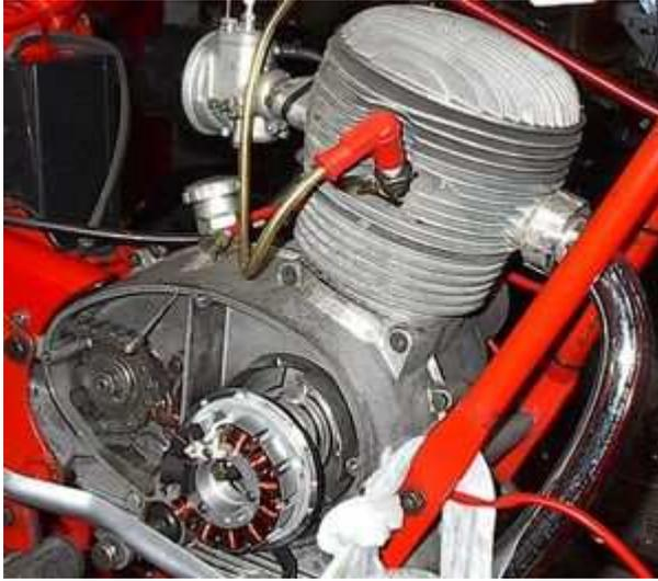
Platzieren Sie die Grundplatte mit dem lose daran hängenden Stator an die Stelle der alten Lichtmaschine und befestigen sie. Stecken Sie den Stator wieder auf die Grundplatte und achten Sie dabei darauf keine Kabel einzuklemmen. Der Stator muß "hörbar" einrasten, ansonsten können Sie sicher sein, daß ein Kabel eingeklemmt wurde.
