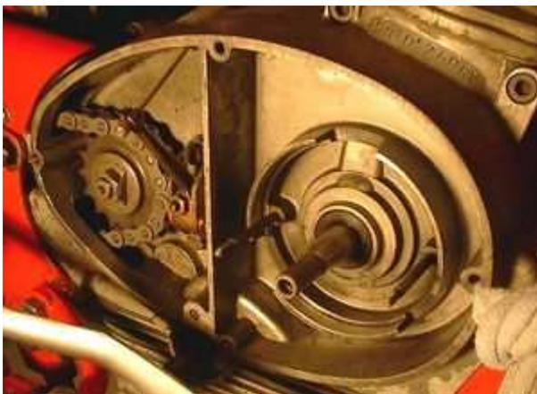
Lösen Sie die Schrauben des Statorgehäuses und nehmen Sie es ab. Ziehen Sie den Rotor mit Hilfe einer geeigneten Abziehschraube von der Kurbelwelle.
