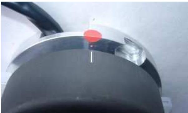
Ist der obere Totpunkt gefunden, ziehen Sie den Rotor wieder vorsichtig ab (dabei nicht die Position der Kurbelwelle ändern!) und setzen ihn so auf, daß die kleine Strichmarkierung des Rotors an der Markierung der Grundplatte steht.
