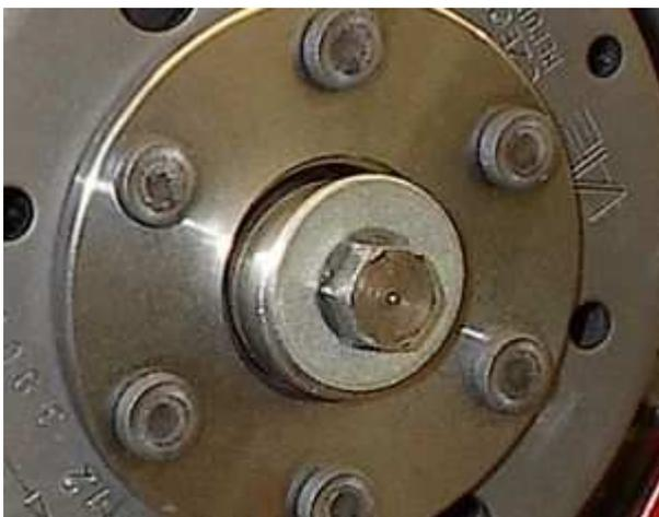
Befestigen Sie den Rotor mit der mitgelieferten Schraube M7x35.
