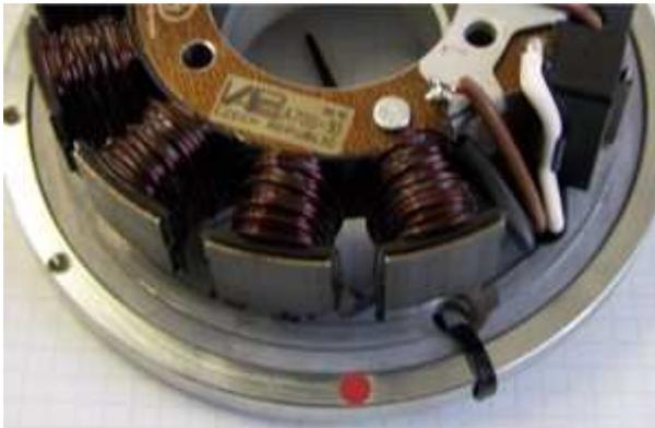
Schauen Sie sich die neue Statoreinheit bitte etwas genauer an. Sie werde in der Nähe der kleineren schwarzen Spulen eine kleine rote Markierung auf der Grundplatte finden.
