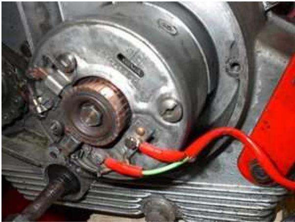
Entfernen Sie den Lichtmaschinendeckel. Dann lösen Sie alle Kabel von der alten Lichtmaschine. Original sollten sich dort ein rotes und ein grünes Kabel befinden.
