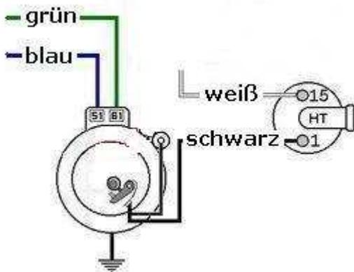
Lösen sie nun alle Kabel an Ihrer alten Lichtmaschine, dem Regler und der Zündspule und entfernen Sie diese Teile. Den alten Rotor bekommen Sie mit Hilfe einer Abziehschraube M8x90 ab.
