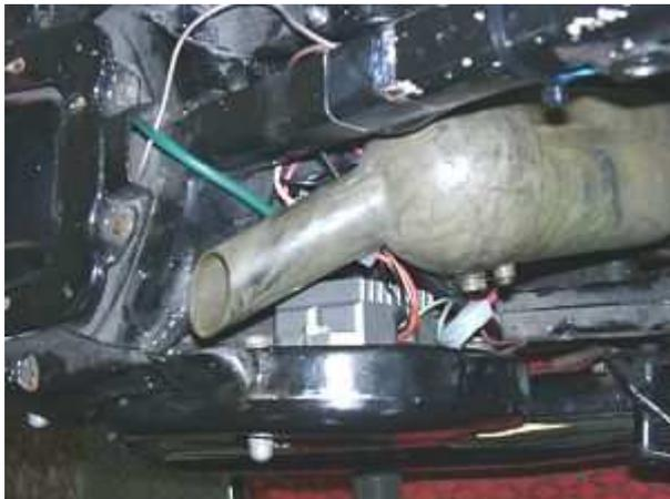
Befestigen sie den elektronischen Gleichrichter/Regler an einer geeigneten Stelle, [z.B. an der inneren Außenseite des Werkzeugkastens](#).
