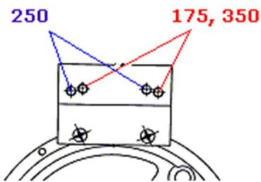
Für die **250er** wird der Sensor nach links geschoben montiert.
