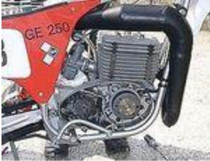
**Vorteile gegenüber dem alten System:****Lichtmaschine/elektronische Zündung für MZ GE 250 mit original Kleinserienzündung 20 mm Welle**
