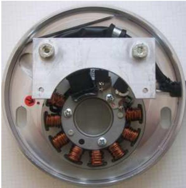
Sehen Sie sich die neue Grundplatte der Lima an. Hier finden Sie (im montierten Zustand bei etwa 9 Uhr) eine rote Zündmarkierung.
