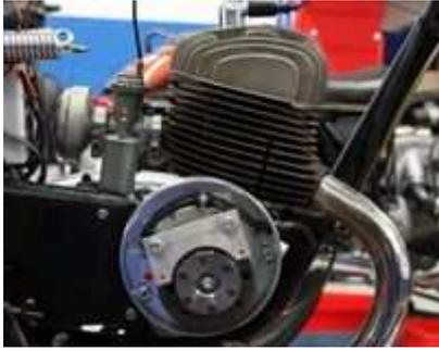
Lichtmagnetzündanlage mit integrierter vollelektronischer Zündung. Lichtleistung 12V/100W Gleichstrom.
