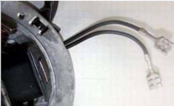
Die beiden schwarzen aus der Lichtmaschine kommenden Kabel führen die Spannung für Licht, Hupe, Blinker usw. Sie haben, [wie der Regler überhaupt, nichts mit der Zündung zu tun.](#)
