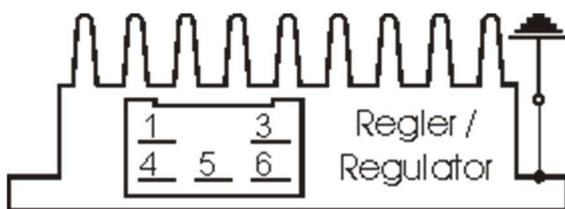
Der neue Regler/Gleichrichter hat einen Kompaktstecker mit 6 Steckmöglichkeiten, von denen eine frei ist. Zu dem Regler wird ein passendes Gegenstück geliefert in welches nachfolgende Kabel einzuführen sind und die dort einrasten müssen.
