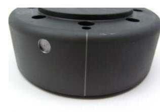
Sehen Sie sich jetzt den neuen Rotor an. Auf seinem Umfang finden Sie eine kleine eingepresste Strichmarkierung. Das ist eine Zündeinstellmarke. Diese ist durch die Einpressung dauerhaft aber eingebaut nicht immer gut zu sehen. Ein Nachziehen mit Faserstift ist daher eine gute Idee.
