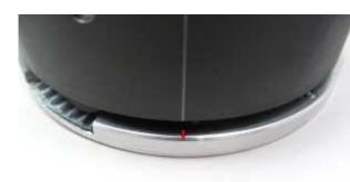
Entfernen Sie die Zündkerze und bringen Sie den Kolben in Zündzeitpunktstellung. Sie können dazu den neuen Rotor locker auf die Welle stecken und diese damit drehen. Informieren Sie sich in ihrem Handbuch nach den richtigen Wert.
