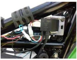
Befestigen Sie nun die neue Zündspule und den neuen Regler an einem geeigneten Ort. Zweckmäßigerweise mit an der Halteschelle der Zündspule.
