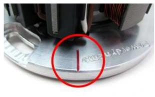
Schauen Sie sich die neue Statoreinheit an. Sie werden nahe der schwarzen Spulen eine rote Zündmarkierung finden.
