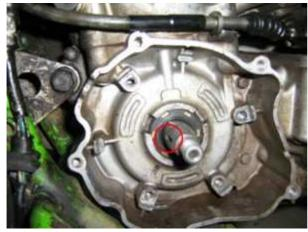
Entfernen Sie die Passfeder aus der Kurbelwelle, die in die Nut des alten Limarotors ging. Keine Angst, sie hat keine Haltefunktion, sondern sollte nur zur Zündeinstellung führen. Vergessen Sie die Paßfeder zu entfernen, geht später der Rotor nicht auf die Welle und Sie müssen den Stator erneut abbauen um an den Stift zu kommen.
