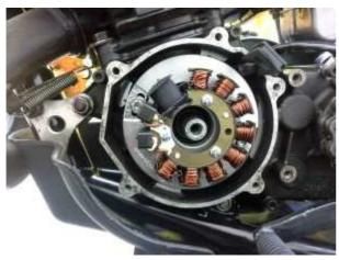
Setzen Sie die neue Bodenplatte mit dem Stator in den Ort Ihrer alten Stators und befestigen Sie die Platte mit dem im Lieferumfang befindlichen 2 Schrauben M5 (Bitte keinen anderen Schrauben nehmen, da der Kopf zu hoch sein könnte!).
