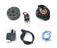
Lichtmagnetzündanlage mit integrierter vollelektronischer Zündung. Lichtleistung 12V/100W Gleichstrom. Kontaktlose elektronische Zündung. Ersetzt die komplette alte Magnet-Licht-Zündanlage, Sensor, Regler und Zündspule.
