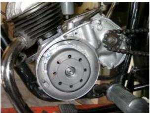
Verschrauben Sie den Rotor mit der originalen Befestigungsmutter. Sie werden alle oder einige der mitgelieferten Unterlegscheiben unterlegen müssen.
