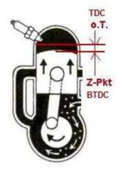
Zum Messen der Kolbenposition benötigen Sie ein Werkzeug (eine Meßuhr oder einen Meßstab, den man z.B. aus einer alten Zündkerze anfertigen kann. Zur großen Not geht aber auch ein Bleistift und etwas Augenmaß).
