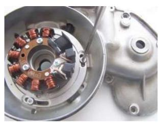
Führen Sie den Statorkabelbaum vorsichtig durch die entsprechende Öffnung des Motors. Setzen Sie die Statoreinheit auf den Motorblock und verschrauben Sie ihn dort (wie in der Abbildung gezeigt).
