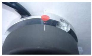
Wenn Sie die Zündposition gefunden haben, nehmen Sie den neuen Rotor vorsichtig wieder ab und stecken Sie ihn wieder so auf, daß die Markierung auf der Außenseite des Rotors auf Höhe der Markierung auf der Grundplatte des Stators zu stehen kommt.
