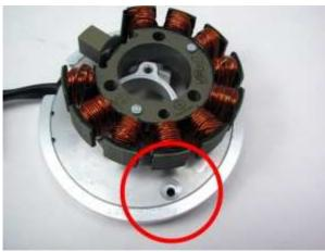
Lösen Sie zunächst die Statorspule (3 Schrauben M4x25) von der vormontierten Statoreinheit und ziehen Sie den Stator etwas von der Platte
