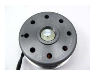
Setzen Sie den Rotor auf die montierte Statoreinheit.
