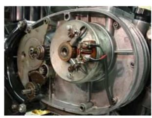
Entfernen Sie die Lichtmaschine und die Zündspule.
