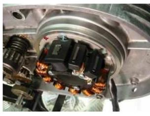
Der gesamte Aufbau wird jetzt mit den beiden Senkkopfschrauben M6 am Motor verschraubt.
