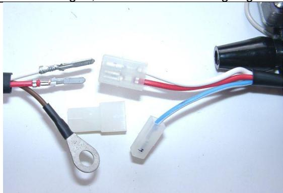
... nehmen Sie den weiblichen Stecker der Zündspule mit den Kabelfarben rot und weiß. Stecken Sie die lose mitgelieferte 2er-Steckerhülse auf diesen Stecker und führen Sie die losen Kabel der Lichtmaschine (rot und weiß) mit den Kontaktfahnen hinten in den Stecker ein. Achten Sie darauf, daß die Steckerfahnen in dem Steckergehäuse einrasten. Dabei ist strikt auf die korrekte Position dieser Kabel im Stecker zu achten:
