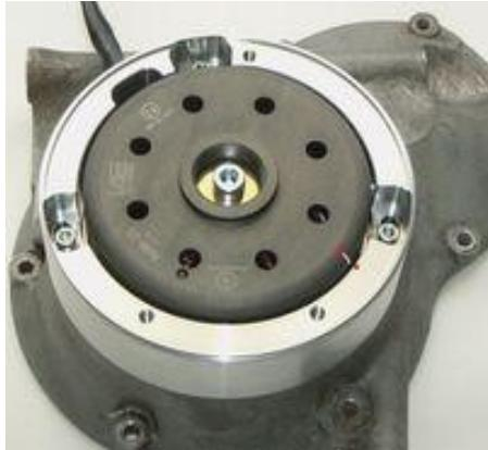
**Gerador/ignição eletrónica para BMW R24/
