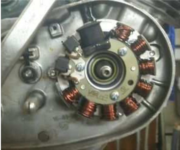
Setzen Sie die Grundplatte mit der lose daran hängenden Statorspule auf den Motor.
