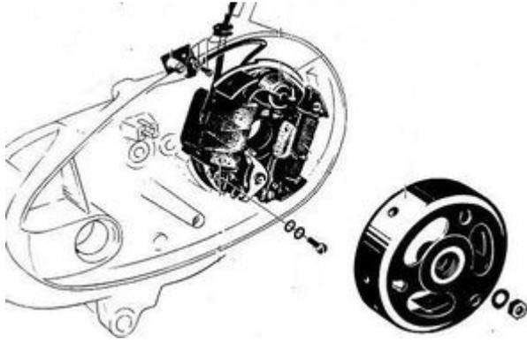
Lösen sie nun alle Kabel an Ihrer alten Lichtmaschine und der Zündspule und entfernen Sie diese Teile.
