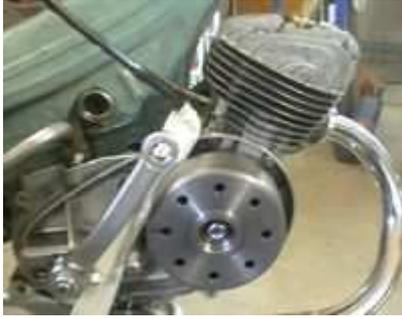
Das System führt nur Wechselstrom und ist daher nicht auf die Ladung einer Batterie und/oder den Betrieb von Blinkern ausgelegt. (Wer das möchte, bestellt bitte eine Version mit dem größeren Gleichstromregler!)
