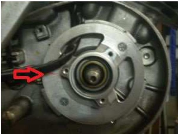
Da die Zündmarke auf der Grundplatte nach Aufsetzen des Rotors leider nicht mehr sichtbar ist, müssen Sie die Markierung entweder auf den Motorblock verlängern oder sich eine markante Stelle am Block merken, die über den Rotor hinaus sichtbar bleibt.
