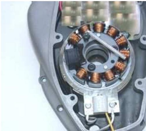
Setzen Sie die aus dem Stahlring, der Aluminiumplatte und dem Sensor bestehende Statorplatte anstelle der früheren Lichtmaschine in das Kurbelgehäuse. Der Sensor weist dabei nach unten, das Kabel geht (wenn man von vorn auf die Anlage sieht) links hoch zum Kabelausgang des Motorblocks.
