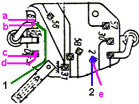
Sehen Sie in das geöffnete Lampengehäuse. Suchen Sie die Kabel des 3adrigen originalen Kabelbaum, der vom Motor kommend an das Zündschloss gehen (hier als a, c und e dargestellt). Der Strang wird komplett entfernt.
