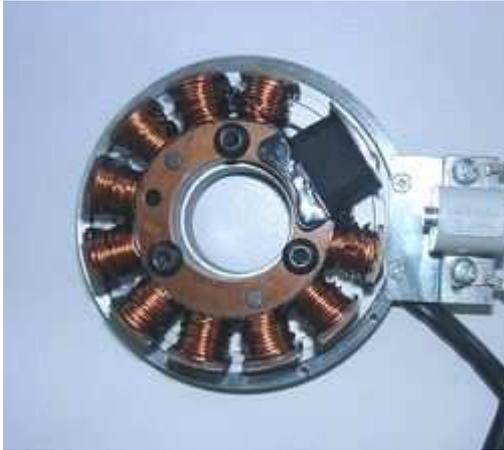
Die **neue Statoreinheit** ist vormontiert damit deren Aufbau leichter erkennbar ist. Für die Montage muss sie teilweise demontiert werden.
