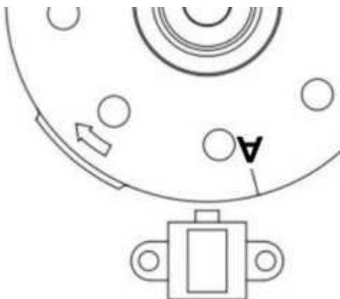
Sehen Sie sich den neuen Rotor an. Sie werden auf seinem Außenumfang ein erhabenes Zeichen finden. Dieses dient der Impulsgebung. Da das System die Frühzündung in Abhängigkeit von der Drehzahl berechnet und diese Berechnung auf der Zeit basiert, die das Zeichen zum Vorbeigang am Sensor benötigt, liegt der Zündzeitpunkt stets nach kompletten Durchgang des Zeichens am Sensor.
