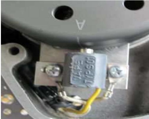
Bleibt das Aufsetzen des Rotors. Stecken Sie ihn zunächst lose auf und prüfen, ob er frei über der Grundplatte läuft. Lassen Sie den Rotor gleich aufgesetzt um ihn jetzt zum Drehen der Kurbelwelle zu nutzen, denn Sie müssen OT einstellen.
