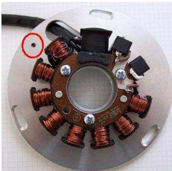
Die Grundplatte hat - etwas links von der Kabelöffnung - eine kleine rote Markierung. Dies ist eine Zündmarkierung.
