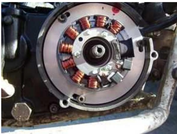
Setzen Sie die Grundplatte auf den Motorblock und verschrauben Sie sie mit den mitgelieferten M5 Schrauben und Unterlegscheiben. Nehmen Sie bitte keine anderen Schrauben, die einen höheren Kopf haben - der Rotor könnte daran schleifen!
