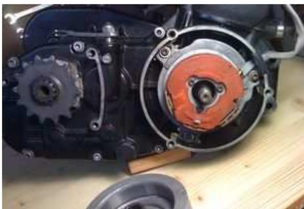
Entfernen Sie den originalen Motoplat (bzw. SEM) Rotor. Dazu benötigen Sie einen Abzieher M26x1.5 (nicht im Lieferumfang)
