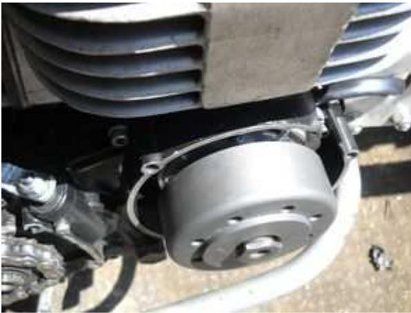
Verschrauben Sie jetzt den Rotor mit der originalen Mutter und Unterlegscheibe.
