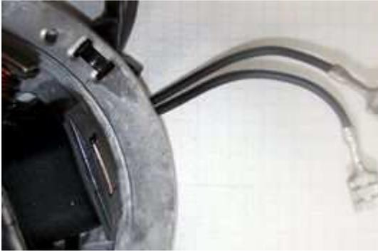
Die beiden schwarzen aus der Lichtmaschine kommenden Kabel führen die Spannung für Licht, Hupe, Blinker usw. Sie haben nichts mit der Zündung zu tun.
