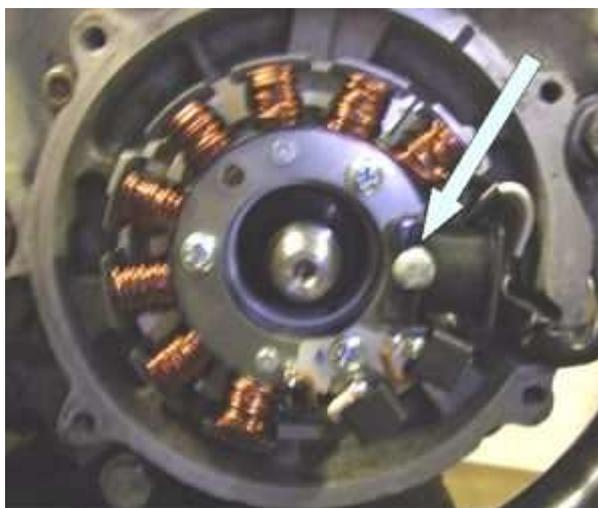
Der Platz zwischen Rotor und Stator ist knapp bemessen. An der Kurbelwelle können eventuell Maßänderungen durch Aufarbeitung entstanden sein. Ebenso kann es sein Sie beugen das System in einen Motor ein für den das System nicht geeignet ist. Daher empfehlen wir dringend den folgenden Test:
