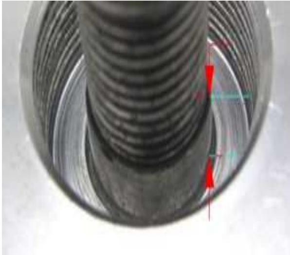
Weiterhin müssen Sie prüfen, ob das Gewinde am Konusende ausreicht den Rotor mit der Mutter fest anzuziehen. Bei einigen Wellen kann es sein, dass der konische Teil der Welle etwas in die Öffnung für die Schraube reicht (siehe Bild links). Dann besteht die Gefahr, dass der Rotor durch die Rotormutter nicht ausreichend fest angezogen werden kann. Dadurch kann der Rotor verrutschen und der Zündzeitpunkt stimmt nicht mehr.
