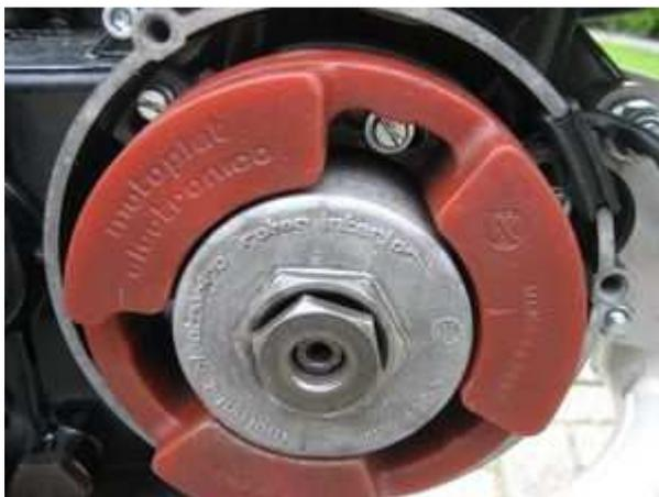
Das System kann auch Motoplatt Innenläufer ersetzen.
