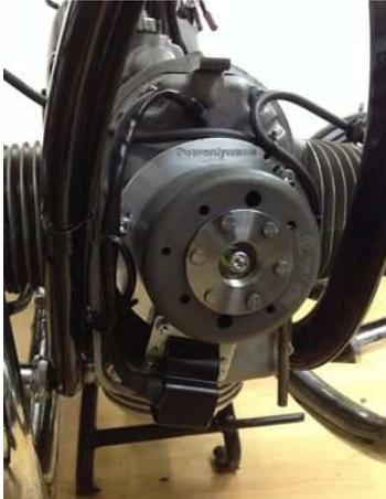
Lichtmagnetzündanlage mit integrierter kontaktloser, drehzahlabhängig automatisch verstellender Zündung. Lichtleistung 12V/180W Gleichstrom. Ersetzt alte [Lichtzündmaschine vom Typ Noris](#) nebst Regler und Verstellmechanismus. Sie benötigen an Ihrem Motorgehäuse keine Veränderungen. Technisch gesehen Sie können das System komplett [ohne Batterie](#) fahren. Die Zündung ist in der neuen Lima integriert.
