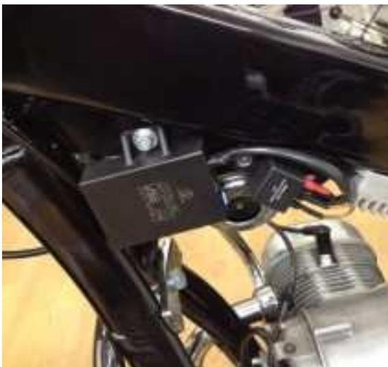
Nun sind die Steuereinheit und der Regler/Gleichrichter am Motorrad unterzubringen. Der Regler ist hinreichend dimensioniert und benötigt keine direkt Frischluft.
