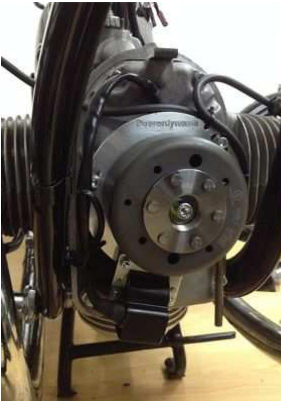
Setzen Sie jetzt die neue Grundplatte mit der daran befestigten Zündspule auf den Motorblock. Befestigen Sie sie dort mit den 3 Schrauben M5x12, wobei Sie etwa die Mitte der Langlöcher nutzen. Ziehen Sie diese Schrauben zunächst nur lose an.
