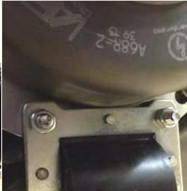
Setzen Sie jetzt den neuen Rotor auf die Welle. Prüfen Sie das der Rotor nirgends schleift, auch nicht am Halter der Zündspule an dem es nur knapp vorbei geht.
