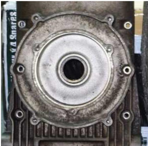
Entfernen Sie die originale Bosch-Lichtmaschine und ziehen Sie den Rotor von der Kurbelwelle ab.
