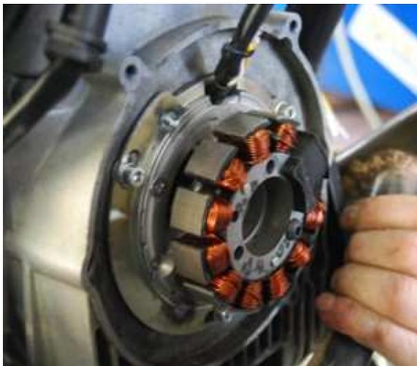
Setzen Sie die vormontierte Statoreinheit auf den Motorblock. Befestigen Sie sie mit den mitgelieferten 3 M5x12 Schrauben und Unterlegscheiben.
