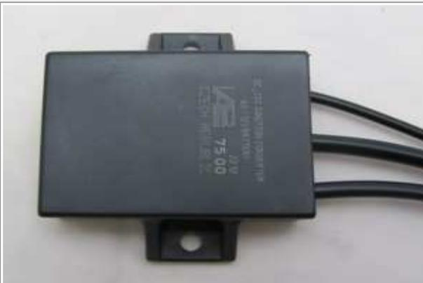
Die Kondensatorzündung wird aus einer über Konverter aus der Batteriespannung erzeugten Wechselspannung von 340 Volt gespeist.
