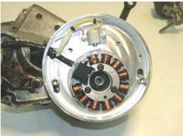
Nehmen Sie die vormontierte Deckelhalteplatte von der neuen Lima ab und stecken Sie die vormontierte Einheit Grundplatte/Stator an die Aufnahme für die Lichtmaschine des Kurbelgehäuses und verschrauben Sie diese mit den beiden Schrauben M8.
