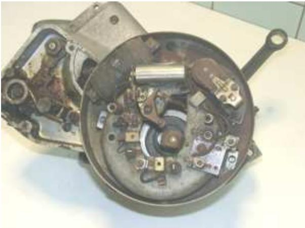
Lösen Sie nun alle Kabel an Ihrer alten Lima und entfernen Sie diese. Nehmen Sie die Passfeder auf dem Konus der Kurbelwelle mit einer Zange ab. Sie wird nicht mehr benötigt! Bitte nicht vergessen sonst müssen Sie die Lima später noch einmal herausnehmen. Keine Angst, die entfernte Passfeder hatte nicht die Aufgabe den Rotor zu sichern, sondern nur zu verhindern, dass er falsch angesteckt wird.
