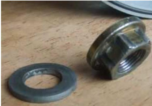
Verschrauben Sie jetzt den Rotor mit der originalen Mutter und Unterlegscheibe.
