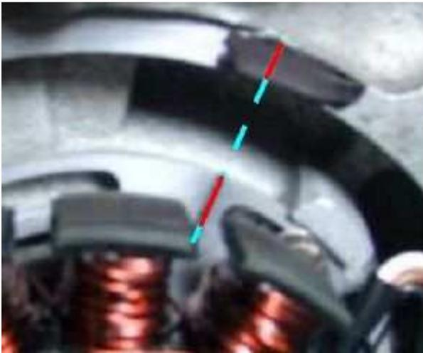
Diese Markierung ist nicht mehr gut sichtbar wenn der Rotor (103mm Durchmesser) aufgesetzt wird. Daher sollten Sie die Markierung auf das Motorgehäuse übertragen wie hier im Bild gezeigt.
