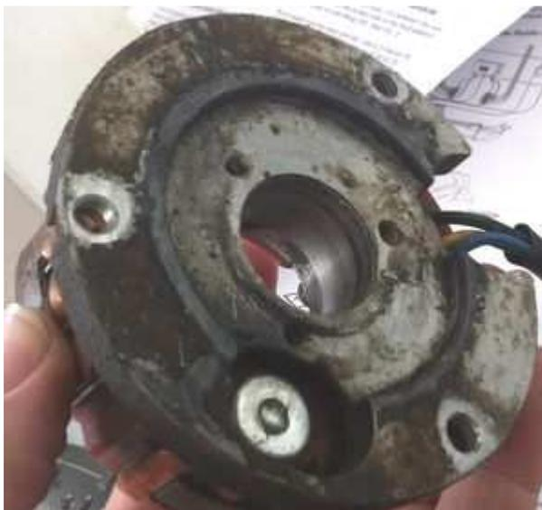
Entfernen Sie das originale System. Dazu benötigen Sie einen Abzieher M26x1.5.
