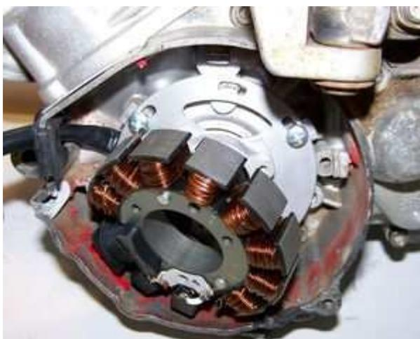
Setzen Sie die vormontierte Statorplatte auf den Motorblock und verschrauben Sie sie mit den mitgelieferten M4 Schrauben. Nehmen Sie bitte keine anderen Schrauben, die einen höheren Kopf haben - der Rotor könnte daran schleifen!
