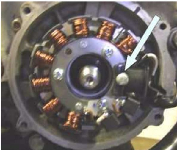
Der Platz zwischen Rotor und Stator ist knapp bemessen. An der Kurbelwelle können eventuell Maßänderungen durch Aufarbeitung entstanden sein. Ebenso kann es sein Sie bauen das System in einen Motor ein für den das System nicht geeignet ist. Daher empfehlen wir dringend den folgenden Test:
