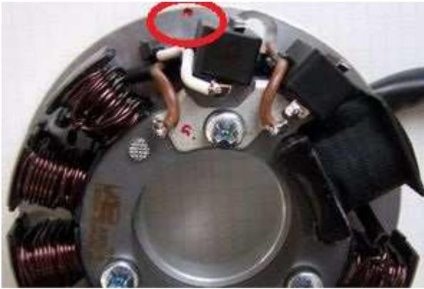
Die Grundplatte hat - etwas links von den kleinen schwarzen Spulen - eine kleine rote Markierung. Dies ist eine Zündmarkierung.
