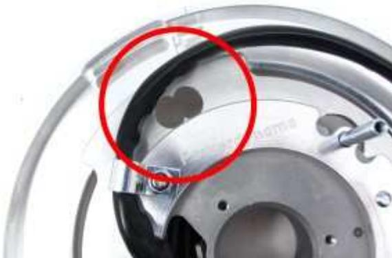
Jetzt wird die vormontierte Statorplatte auf den Motor gesetzt. Dabei muss das Loch zur Zündeneinstellung (siehe Bild) ebenfalls in Richtung des Schraubenloches links zeigen.
