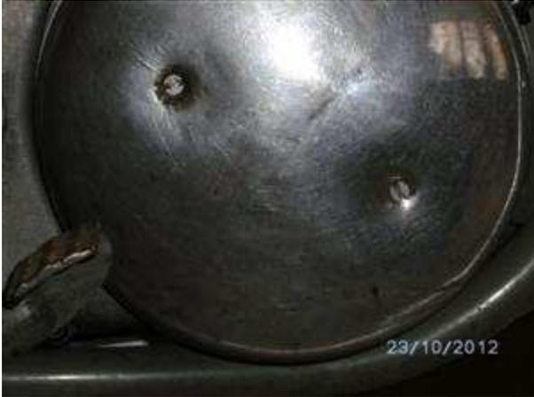
Zum Schluss die Anbringung der originalen Abdeckung. Die Scheibe wird mit je 2 Distanzhülsen auf Abstand gehalten und kann mit den mitgelieferten Schrauben M4 befestigt werden.
