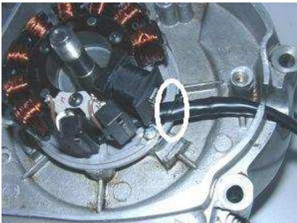
Legen Sie durch die Befestigung auf Höhe Kabelausgang den schmalen, kurzen Kabelbinder und verschrauben Sie die Platte mit den 3 Schrauben M4.
