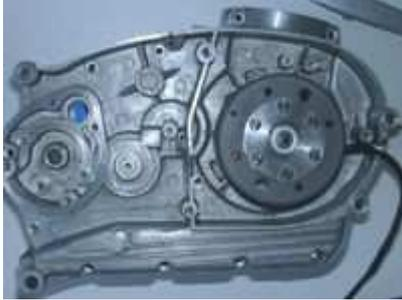
Lichtmagnetzündanlage mit integrierter, drehzahlabhängiger, vollelektronischer Zündung. Lichtleistung 12V/100W Gleichstrom. Kontaktlose elektronische Zündung mit eigener Stromversorgung innerhalb der Anlage. Ersetzt den alten 12V Dansi Magneto und alle Zündungsteile. Sie benötigen an Ihrem Motorgehäuse keine Veränderungen. Sie können das System komplett ohne Batterie fahren (müssen aber dann bei Vorhandensein von Blinkern einen Glättungskondensator einbauen).
