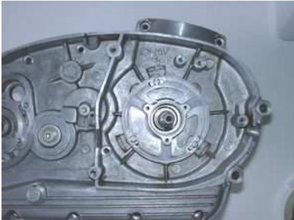
Schrauben Sie den vormontierten Spulenkern von seiner Grundplatte (3 Schrauben M4).
