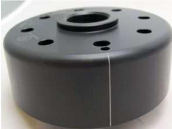
Sehen Sie sich jetzt den Rotor an, auf seinem Außenumfang finden Sie eine kleine Markierung (gekerbte Linie). Hier auf dem Bild zur besseren Erkennbarkeit weiß hervorgehoben.
