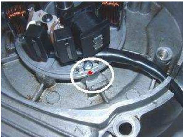
Sehen Sie sich die neue Grundplatte mit dem vormontierten Stator an. Auf ihr finden Sie, mittig zu einem der 3 Befestigungslöcher, auf dem Umfang der Platte eine rote Markierungen. Das ist eine Zündmarkierungen.
