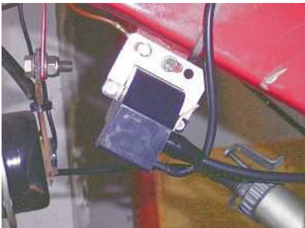
Befestigen Sie die neue Zündspule dort, wo auch die originale Spule befestigt war. Lassen Sie dabei zunächst eine der beiden Schrauben locker. Hier kommt ein Massekabel hin.
