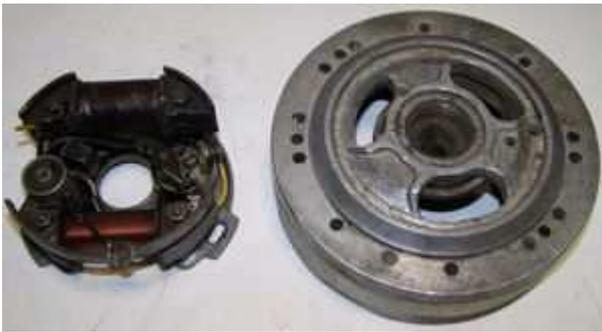
Retirer le volant et les bobinages. Enlevez la clavette sur le cône du vilebrequin avec une pince. Elle n'est plus nécessaire! N'oubliez pas de le faire, autrement vous ne pourriez pas adapter le nouveau rotor correctement. Pas de crainte, la clavette n'a pas pour but de tenir le rotor sur le vilebrequin. Elle ne sert uniquement qu'à simplifier le montage et n'est plus nécessaire dans le nouveau système.
