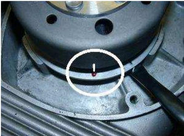
Entfernen Sie die Zündkerze und bringen Sie den Kolben in den oberen Totpunkt. Es ist dabei unerheblich in welchem Takt sich der Motor befindet. Da das ganze per Kickstarter kompliziert ist, setzen Sie den neuen Rotor locker auf den Kurbelwellenstumpf um ihn zum Drehen der Kurbelwelle zu nutzen.
