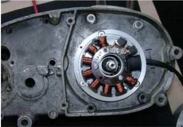
Setzen Sie die nun freie Grundplatte auf den Motor, dorthin, wo auch die alte Grundplatte fixiert war. Die kleine rote Markierung auf dem Umfang kommt auf eine der 3 Halteschrauben auf etwa 10 Uhr.
