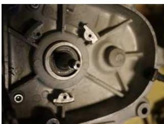
Nehmen Sie die Passfeder auf dem Konus der Kurbelwelle mit einer Zange ab. Sie wird nicht mehr benötigt. Bitte nicht vergessen, sonst müssen Sie die Lima später noch einmal herausnehmen. Die Zündung wird ab jetzt in der Lichtmaschine integriert sein.
