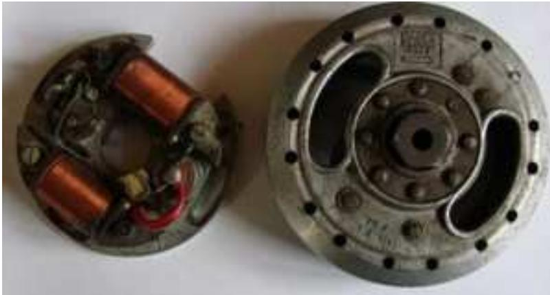
Entfernen Sie die Lichtmaschine und alle Zündungsteile, auch die Zündspule.
