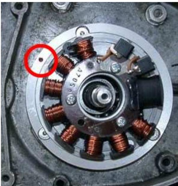
Sehen Sie sich die neue Grundplatte mit dem vormontierten Stator an. Auf ihr finden Sie, mittig zu einem der 3 Befestigungslöcher, auf dem Umfang eine rote Markierung. Das ist eine Zündmarkierung.
