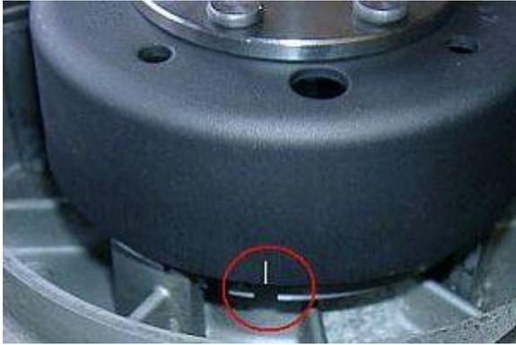
Entfernen Sie die Zündkerze und bringen Sie den Kolben in Zündzeitpunktstellung. Sie können dazu den neuen Rotor locker auf die Welle stecken und diese damit drehen.
