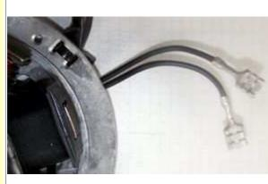
Die beiden schwarzen aus der Lichtmaschine kommenden Kabel führen die Spannung für Licht, Hupe, Blinker usw. Sie haben nichts mit der Zündung zu tun.
