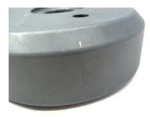
Sehen Sie sich jetzt den neuen Rotor an. Auf seinem Umfang finden Sie eine kleine eingepresste Strichmarkierung. Das ist eine Zündeinstellmarke. Diese ist durch die Einpressung dauerhaft aber eingebaut nicht immer gut zu sehen. Ein Nachziehen mit Faserstift ist daher eine gute Idee.
