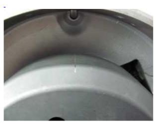
Entfernen Sie die Zündkerze und bringen Sie den Kolben in Zündzeitpunktstellung. Sie können dazu den neuen Rotor locker auf die Welle stecken und diese damit drehen. Informieren Sie sich in ihrem Handbuch nach den richtigen Wert.
