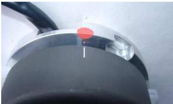
Entfernen Sie die Zündkerze und bringen Sie den Kolben in **Zündposition**. Das sollte (in Abhängigkeit von Ihrem Motorrad) 1-3,5 mm vor OT sein. (Bitte lesen Sie dazu in der Bedienungsanleitung Ihres Motorrades nach!).
