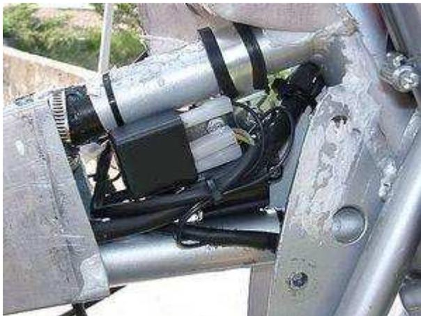
Montieren Sie jetzt den neuen Regler/Gleichrichter ebenfalls an einer geeigneten Stelle. Das Rahmendreieck neben dem Tank (verschraubt mit der Zündspule), unterm Sitz oder der Seitenverkleidung bietet es sich an.
