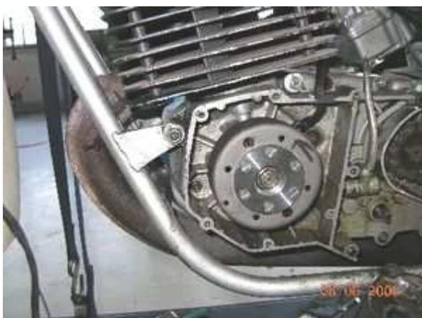
Halten Sie die Stelle des Zündzeitpunktes, nehmen Sie den neuen Rotor vorsichtig wieder ab und stecken Sie ihn so wieder auf, daß die Markierung auf der Außenseite des Rotors auf Höhe der Markierung auf der linken Seite der Statorplatte zu stehen kommt. Legen Sie die originale Unterlegscheibe unter und verschrauben Sie den Rotor mit der originalen Mutter.
