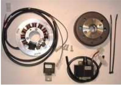
Lichtmagnetzündanlage mit integrierter vollelektronischer Zündung. Lichtleistung 12V/70W Wechselstrom. Kontaktlose elektronische Zündung mit eigener Stromversorgung innerhalb der Anlage. Ersetzt die alte Lichtzündanlage einschließlich Zündspule. Sie benötigen an Ihrem Motorgehäuse keine Veränderungen.
