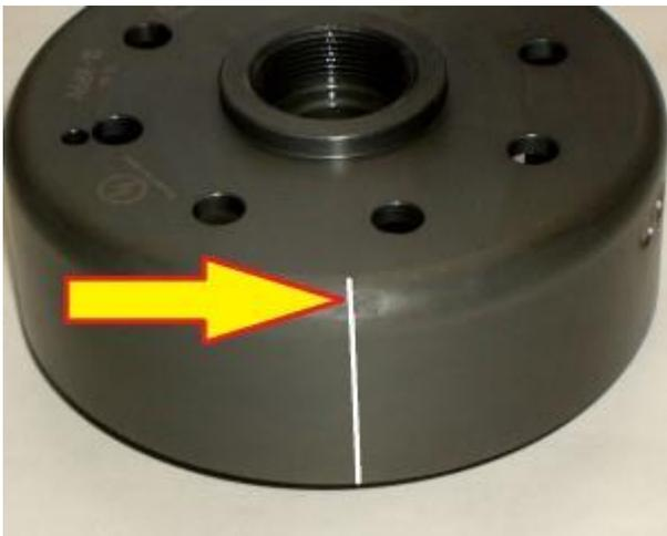
Sehen Sie sich den neuen Rotor an. Sie finden auf seinem Umfang eine eingepresste Markierung.
