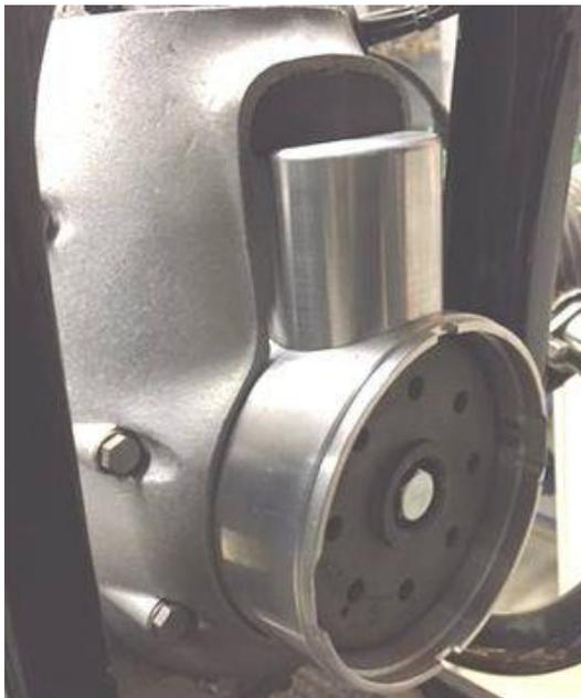
Entfernen Sie die Zündkerzen um eine leichtgängige Drehung der Kurbelwelle zu erhalten. Stecken Sie den Rotor auf die Kurbelwelle (noch nicht verschrauben) und **(WICHTIG!): prüfen Sie, daß sich der Rotor frei über Grundplatte und Spulensatz drehen kann.**
