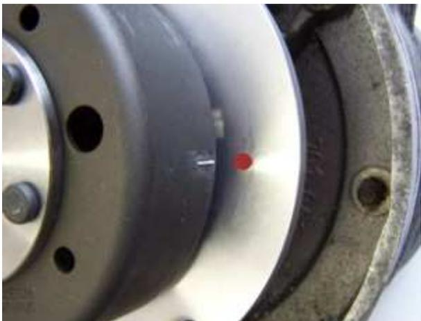
Entfernen Sie die Zündkerze und bringen Sie den Kolben in den oberen Totpunkt. Es ist dabei unerheblich in welchem Takt sich der Motor befindet. Da das ganze per Kickstarter kompliziert ist, setzen Sie den neuen Rotor locker auf den Kurbelwellenstumpf um ihn zum Drehen der Kurbelwelle zu nutzen.
