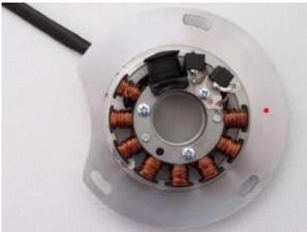
Sehen Sie sich die neue Grundplatte mit dem vormontierten Stator an. Dort finden Sie eine rote Markierung. Diese wird für die Zündeneinstellung benötigt.
