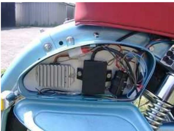
Befestigen sie den elektronischen Gleichrichter/Regler und den elektronischen Zündversteller (Steuereinheit) an einer geeigneten Stelle, z.B. im Seitenfach.
