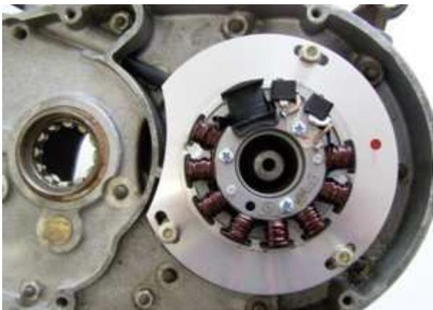
Verschrauben Sie die neue Statorgrundplatte mit den 3 Schrauben M6 am Kurbelgehäuse. Vergessen Sie nicht die beigelegten Unterlegscheiben.
