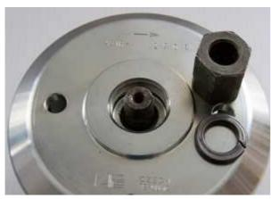
In der Position verschrauben Sie den Rotor sorgfältig mit der originalen Befestigungsmutter.
