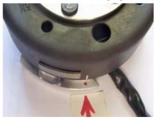
Entfernen Sie die Zündkerze und bringen Sie den Kolben in die Position "Zündzeitpunkt". (Evtl. 2mm vor OT, doch konsultieren Sie dazu die Betriebsanleitung des Motorrades!) Da das ganze per Kickstarter kompliziert ist, nutzen Sie den neuen Rotor zum Drehen der Kurbelwelle.
