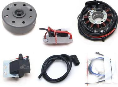
**Vorteile gegenüber dem alten System:****Lichtmaschine/elektronische Zündung für Hodaka 125 / Hodoka 100 Road Toad**
