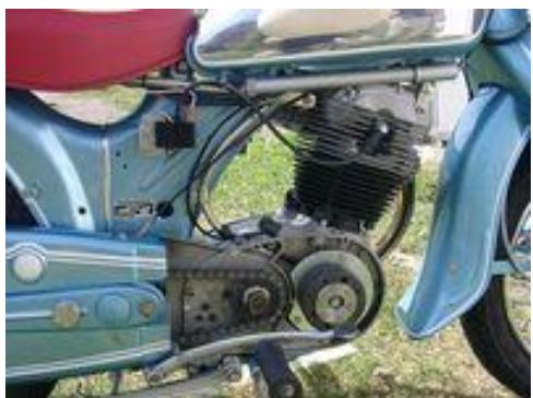
**Lichtmaschine/elektronische Zündung für NSU Max (Standard, Spezial, Supermax)**
