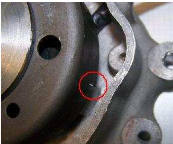
Ist die OT Position gefunden, ziehen Sie den Rotor wieder vorsichtig ab (dabei nicht die Position der Kurbelwelle ändern!) und setzen ihn so auf, daß die Strichmarkierung des Rotors an der seitlichen Markierung der oben geschriebenen roten Markierung der Grundplatte steht.
