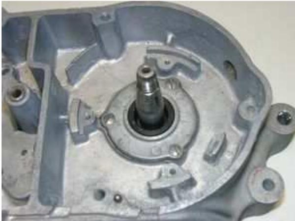
Nehmen Sie den Lichtmaschinendeckel des Motors ab. Lösen sie nun alle Kabel an Ihrer alten Lichtmaschine.
