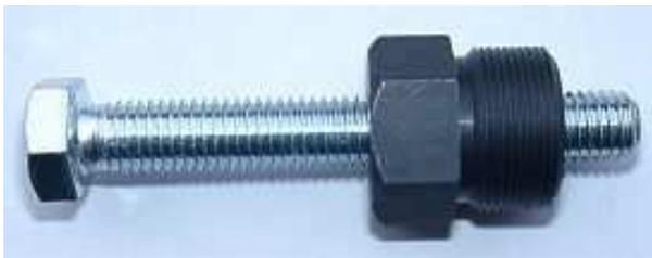
Um den alten Rotor abziehen benötigen Sie einen Abzieher M22x1. Für den neuen Rotor benötigen Sie einen Abzieher M27x1,25 (Bestell-Nr.: 99 99 799 00 -**Nicht im Lieferumfang!**).
