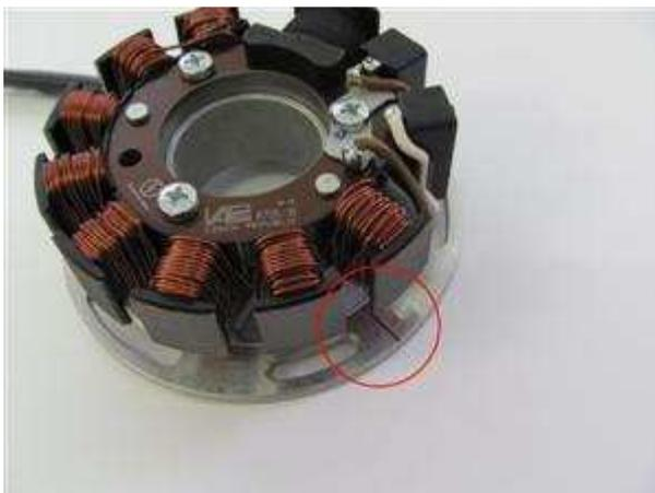
Sehen Sie sich die Grundplatte des neuen Stators an. Etwa auf Höhe der dicken schwarzen Spule finden Sie eine kleine rote Markierung.
