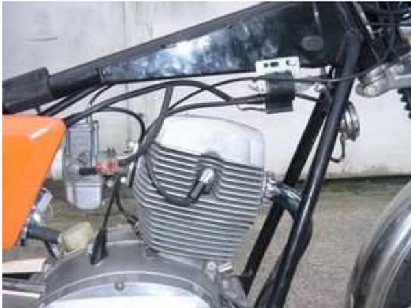
Jetzt geht es daran, die externen Teile, also die Zündspule, den Regler und die Steuereinheit möglichst wenig sichtbar am Motorrad zu befestigen. Die neue Zündspule wird zweckmäßigerweise am Rahmen unter dem Tank befestigt.
