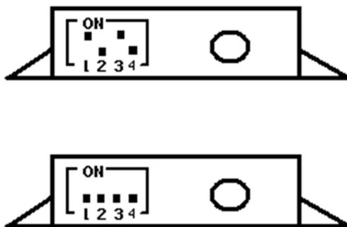
Für die Morini ist nebenstehende Schalterposition zu aktivieren. Damit startet die Zündung bei 4°, hält diese bis kurz über den Leerlauf und steigert dann die Frühzündung linear bis zunächst 34° bei 2.500U/min und dann 38° bei 3.500U/min.
