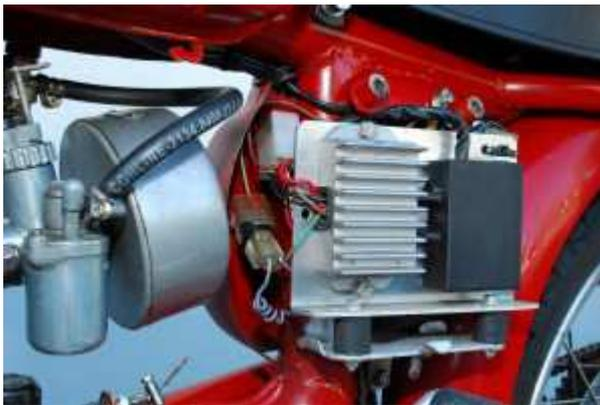
Sie müssen des weiteren den neuen Regler/Gleichrichter und die Zündverstelleinheit am Fahrzeug unterbringen. Das kann z.B. am hinteren Schutzblech erfolgen. Eine weitere Möglichkeit ist ein Seitenkasten.
