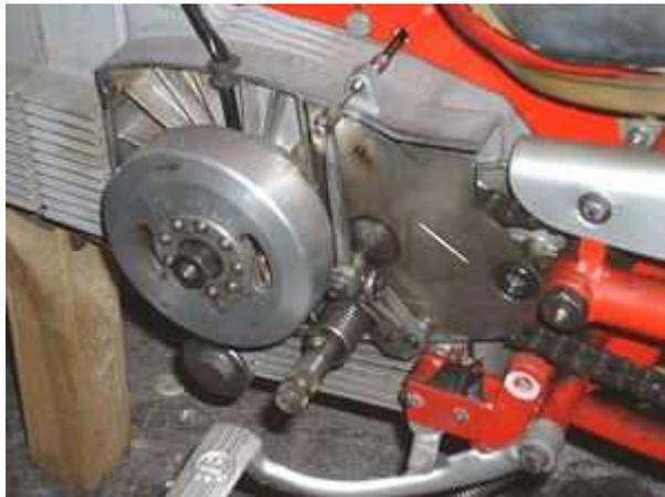
Entfernen Sie Lichtmaschine und die Zündspule.
