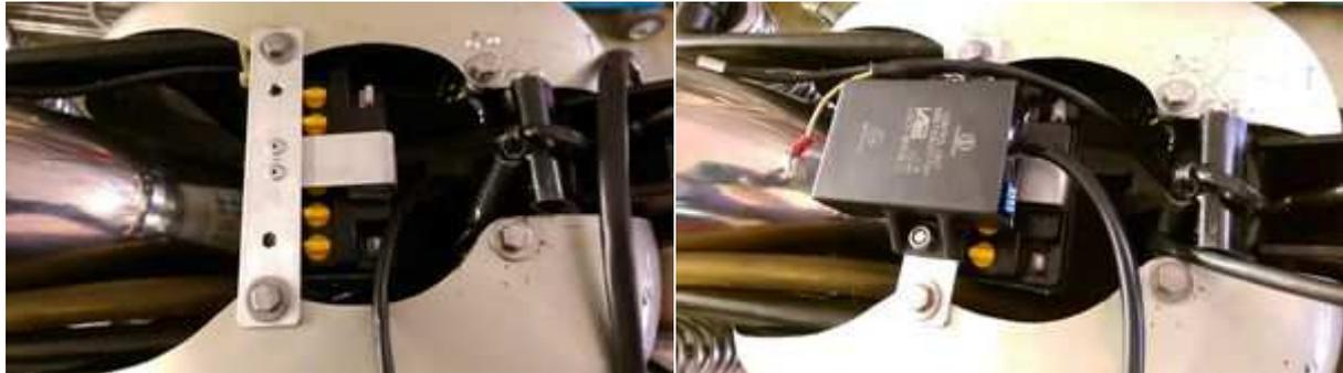
Sehen Sie sich bitte bei der Montage der Steuereinheit den kleinen blauen Schalterblock an der oberen Schmalseite der schwarzen Zündverstelleinheit an. Hier sind 4 kleine, von uns voreingestellte Schalter, die verschiedene Zündverstellkurven wählen.
