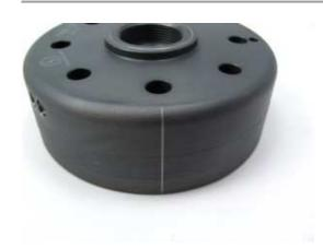
Schauen Sie sich den neuen Rotor an. Auf seinem Außenumfang ist eine gelaserte Linie. Dies ist ebenfalls eine Zündmarkierung.
