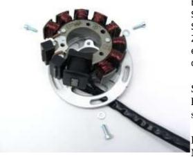
Entfernen Sie die 3 Schrauben, die den neuen Stator auf seiner Grundplatte halten und ziehen Sie ihn etwas von der Platte weg, so dass Sie Zugang zu den Befestigungslöchern darunter erhalten. Achten Sie darauf, die Lackisolierung der Spulendrähte nicht zu beschädigen.
