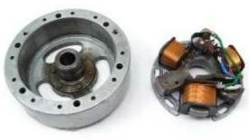
Entfernen Sie die alte Lichtmaschine. Dazu werden Sie einen Rotorabzieher M19x1 benötigen.
