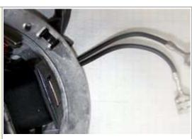
Die beiden schwarzen aus der Lichtmaschine kommenden Kabel führen die Spannung für Licht, Hupe, Blinker usw. Sie haben nichts mit der Zündung zu tun.
