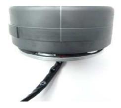
Setzen Sie den Rotor locker auf die Kurbelwelle auf. Überprüfen Sie, dass der Rotor sich frei über die Grundplatte und die Statorspulen drehen läßt und nirgends schleift.
