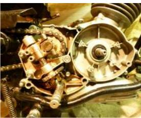
Entfernen Sie den Paßstift auf der Kurbelwelle, der in die Nut des alten Limarotors ging. Keine Angst, der hat keine Haltefunktion, er sollte nur zur Zündeinstellung führen.
