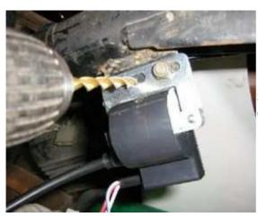
Befestigen Sie die Zündspule am Rahmen, am Besten an dem Platz der alten Zündspule.
