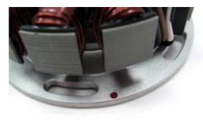
Schauen Sie sich die neue Statoreinheit an. Sie finden auf der Grundplatte eine rote Markierung. Das ist eine Zündmarkierung.
