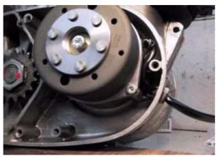
Führen Sie das neue Limakabel durch den Kabelausgang des Motors nach außen. Setzen Sie dort wieder eine Gummitülle auf um Wassereintritt und Scheuern zu verhindern.
