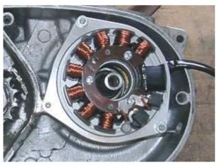
Setzen Sie die vormontierte Einheit Grundplatte/Stator an die Aufnahme für die Lichtmaschine des Kurbelgehäuses. Stellen Sie sicher, daß das Kabel sauber ohne einzuklemmen durch die vergrößerte Öffnung geht. Verschrauben Sie die Statoreinheit am Kurbelgehäuse mit den 3 Schrauben M6.
