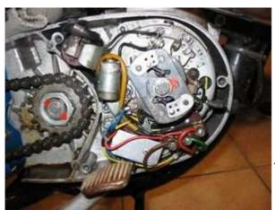
Entfernen Sie die alte Lichtmaschine, den Regler und die Zündspule.
