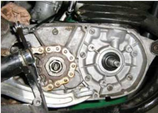
Entfernen Sie den Paßstift auf der Kurbelwelle, der in die Nut des alten Limarotors ging. Keine Angst, der hat keine Haltefunktion, er sollte nur zur ZündEinstellung führen. Vergessen Sie den Stift zu ziehen, geht später der Rotor nicht auf die Welle und Sie müssen den Stator erneut abbauen um an den Stift zu kommen.
