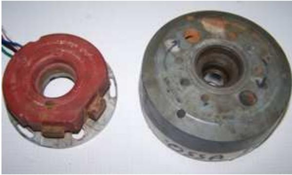
Lösen sie nun alle Kabel an Ihrer alten Lichtmaschine und entfernen Sie diese. Ziehen Sie den Rotor ab, dazu werden Sie einen entsprechendes Abziehwerkzeug benötigen. Lösen Sie die Schrauben des alten Stators und nehmen Sie ihn aus dem Motor.
