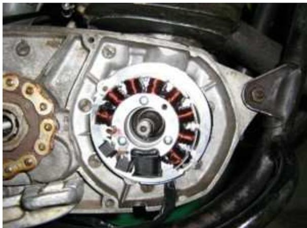
Setzen Sie jetzt die neue Statoreinheit auf den Lichtmaschinensitz des Motors und befestigen Sie diese mit den 3 mitgelieferten Schrauben M5.
