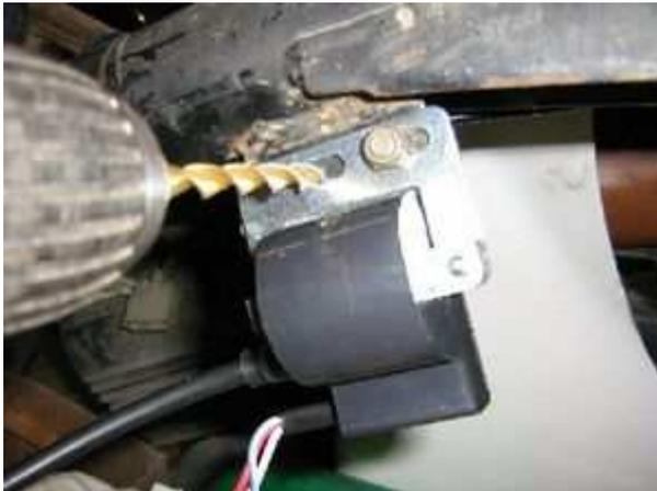
Befestigen Sie die Zündspule am Rahmen, am Besten an dem Platz der alten Zündspule.
