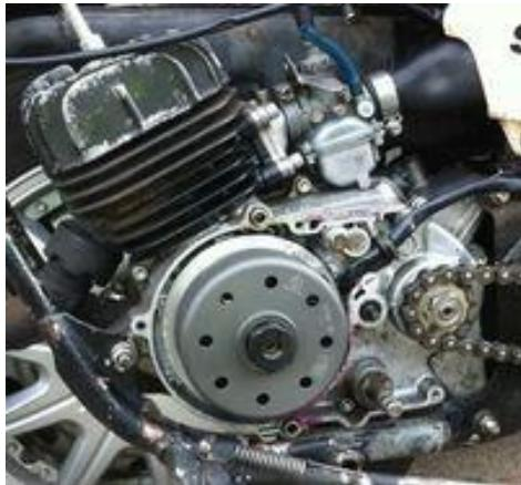
**Générateur avec allumage à semi-conducteurs intégré pour Yamaha TY 50/80 ainsi que DT50(2M5) et RD50**
