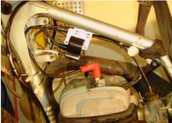
Befestigen sie die neue elektronische Zündspule am Rahmen des Motorrades, z.B. an der selben Lasche, an der schon die originale Zündspule war, wobei Sie ggf. eine Anpassung fertigen müssen da der Lochabstand anders sein kann.
