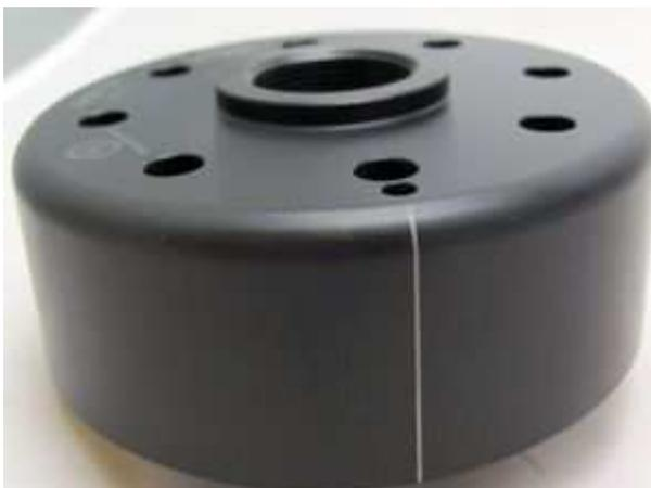
Sehen Sie sich den neuen Rotor an. Sie werden am Rand seiner Oberfläche eine Strichmarkierung finden. Auch das ist eine Zündmarkierung.
