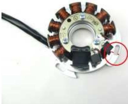
(Bild zeigt den Stator mit Lichtspulen!)
