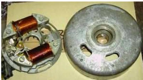
Nehmen Sie die Passfeder vom Konus der Kurbelwelle mit einer Zange ab. Sie wird nicht mehr benötigt! Bitte nicht vergessen sonst müssen Sie die Lima später noch einmal herausnehmen. Keine Angst, die entfernte Passfeder hatte nicht die Aufgabe den Rotor zu sichern, sondern nur zu verhindern, dass er falsch angesteckt wird.
