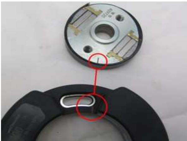
Bringen Sie jetzt einen (gleichgültig welchen) Kolben in Zündposition. In dieser Kurbelwellenstellung setzen Sie jetzt den Rotor so auf die Kurbelwelle, daß dessen kleine rote Punktmarkierung genau an der roten Strichmarkierung des Stators steht und verschrauben ihn dort. Dabei darf sich die Stellung der Kurbelwelle nicht verändern.
