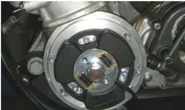
Setzen Sie die Adapterplatte so auf das Kurbelgehäuse, dass die Kabelöffnung der Platte in Richtung des Kabelausganges zeigt. Verschrauben Sie die Platte mit den 4 beiliegenden Schrauben M4x16.
