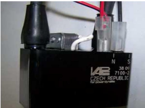
Der breitere 6,3mm Kontakt an dem rot/weißen Kabel bringt die Zündspannung (mehrere hundert Volt Wechselstrom), der schmalere 4,2mm Kontakt an dem schwarzen Kabel den Impuls.
