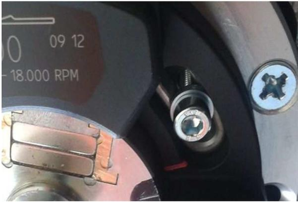
Um die Verstellmöglichkeit in den Langlöchern nicht zu beschränken, sollte der Stator so montiert werden, dass die 3 Halteschrauben jeweils etwa mittig der Langlöcher stehen. Bitte nicht die U-Scheiben 5 vergessen und gut anziehen.
