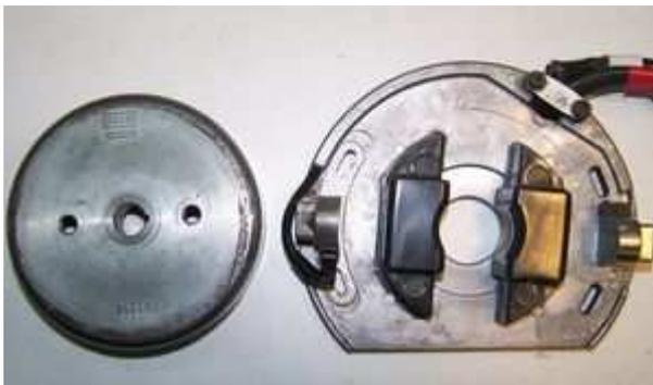
Entfernen Sie die alte Zündanlage, auch die alte Zündspule. Entfernen Sie die Paßfeder auf dem Kurbelwellenstumpf. Sie wird nicht benötigt und stört nun. Keine Angst, die Feder hatte keine Haltefunktion, sondern sollte nur zum richtigen Zündeneinstellung führen. Dies wird jetzt mit Markierungen erledigt.
