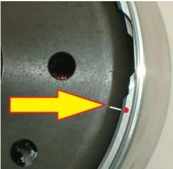
Sehen Sie sich das Gehäuse an. Hier finden Sie rechts von den kleinen schwarzen Spulen eine kleine rote Markierung auf der Oberseite der Gehäusewand.
