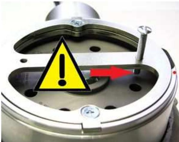
Nach erfolgreichem Motorlauf die Deckelhalterung wieder aufsetzen.
