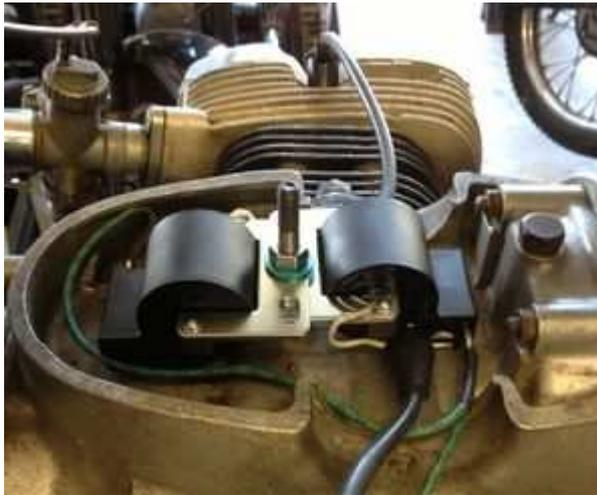
Das System verfügt im Unterschied zum System [73 15 999 00](#) über **2 Einzelzündspulen** da sich die **Doppelspule** wegen ihrer Größe nicht unter dem flachen Deckel der K oder der KS500 sowie 600 unterbringen lässt
