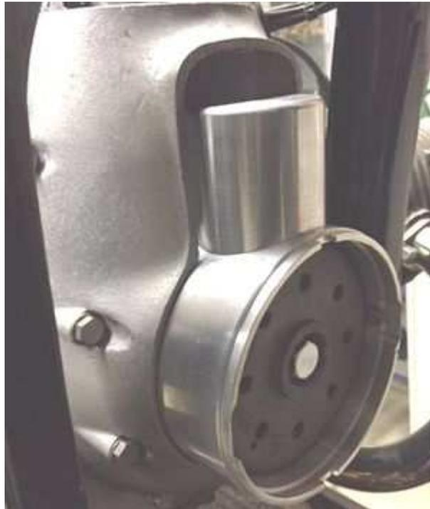
Entfernen Sie die Zündkerzen um eine leichtgängige Drehung der Kurbelwelle zu erhalten. Stecken Sie den Rotor auf die Kurbelwelle (noch nicht verschrauben) und **(WICHTIG!): prüfen Sie, daß sich der Rotor frei über Grundplatte und Spulensatz drehen kann.**
