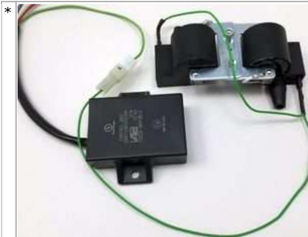
Das grüne Kabel der Steuereinheit wird über das dort aufgesteckte mitgelieferte Verteilerkabel mit dem Steckkontakt der beiden neuen Zündspulen verbunden. Die Spulen sind damit parallel geschaltet
