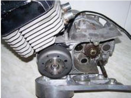
**Vorteile gegenüber dem alten System:****Lichtmaschine/elektronische Zündung für Motor Benelli 125 und 250 2C z.B. in Moto Guzzi 250 TS Elettronica sowie Benelli 125/250 2C**
