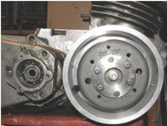
**Lichtmaschine/elektronische Zündung für Velorex 3-Rad (350ccm)**
