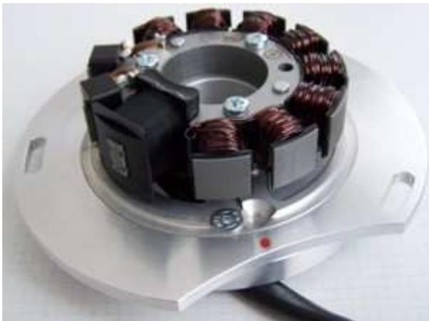
Sehen Sie sich die neue Grundplatte mit dem vormontierten Stator an. Auf Höhe der ersten kupferfarbenen Spule neben der dicken schwarzen, finden Sie eine rote Markierung. Diese wird für die ZündEinstellung benötigt.
