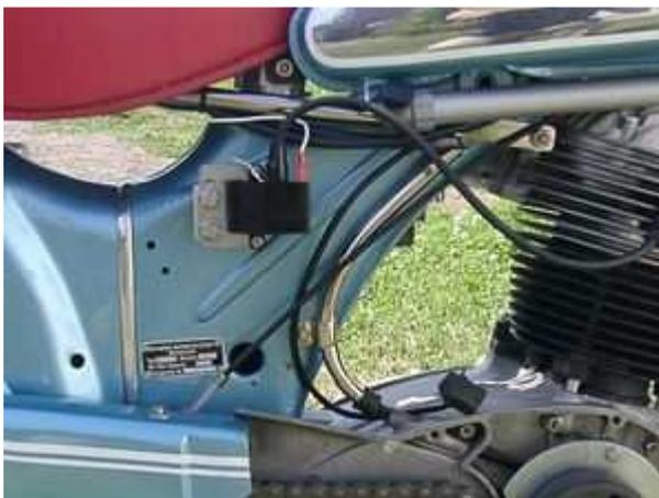
Befestigen Sie die neue Zündspule an einem geeigneten Ort.
