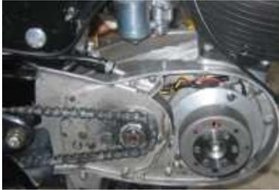
Lichtmagnetzündanlage mit integrierter vollelektronischer Zündung. Lichtleistung 12V/100W Gleichstrom. Kontaktlose elektronische Zündung mit eigener Stromversorgung innerhalb der Anlage. Ersetzt die alte Lichtmaschine, Unterbrecher, Zündspule, Regler. Sie benötigen an Ihrem Motorgehäuse keine Veränderungen. Das System ist technisch gesehen in der Lage [ohne Batterie](#) auszukommen.
