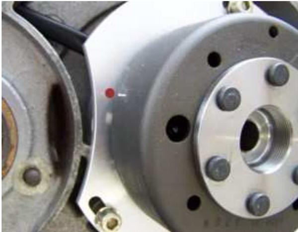
Entfernen Sie die Zündkerze und bringen Sie den Kolben in den Zündzeitpunkt. Das Handbuch gibt für die Super Lux 4.8mm, die Lux 5.8 an. Infolge der nun schnelleren Kraftstoffe und Zündung sollten Sie 4mm bzw. 5mm prüfen. ([mehr Info hier](#)). Da das Ganze per Kickstarter kompliziert ist, setzen Sie den neuen Rotor locker auf den Kurbelwellenstumpf um ihn zum Drehen der Kurbelwelle zu nutzen.
