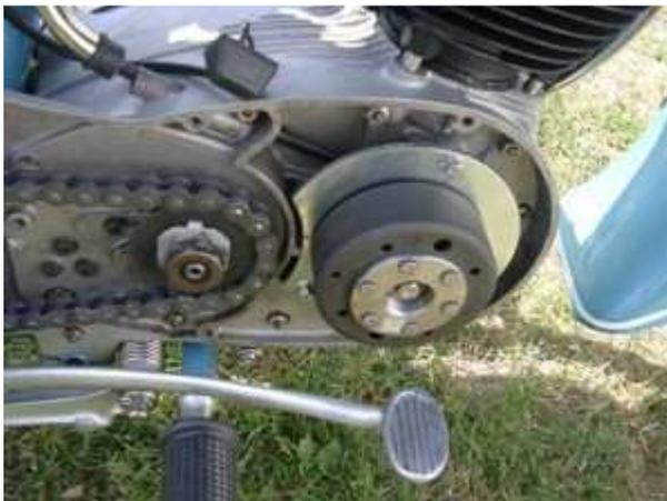
Verschrauben Sie den Rotor mit der Schraube M8x40 sorgfältig. Vergessen Sie dabei die Unterlegscheibe nicht.
