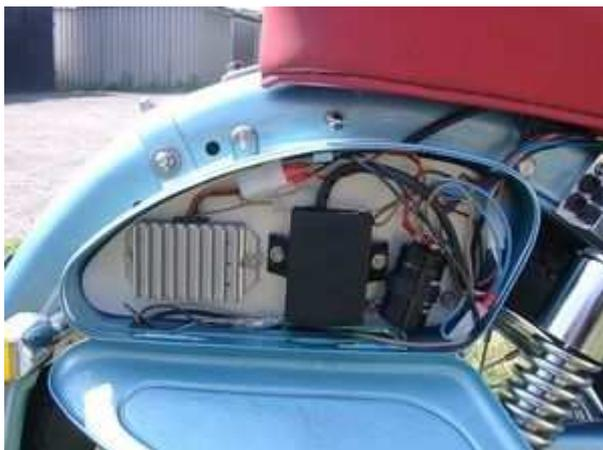
Befestigen sie den elektronischern Gleichrichter/Regler und das Relais an einer geeigneten Stelle, z.B. im Seitenfach.
