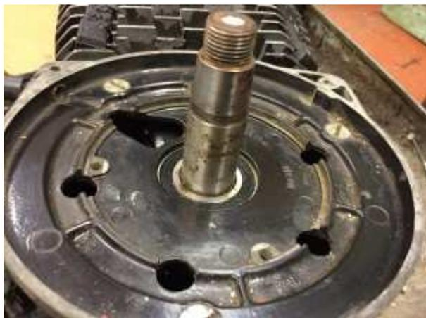
Entfernen Sie den Paßstift auf der Kurbelwelle, der in die Nut des alten Limarotors ging. Keine Angst, der hat keine Haltefunktion, er sollte nur zur ZündEinstellung führen. Vergessen Sie den Stift zu ziehen, geht später der Rotor nicht auf die Welle und Sie müssen den Stator erneut abbauen um an den Stift zu kommen.
