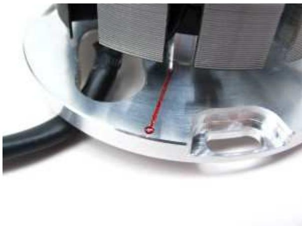
Schauen Sie sich die neue Statoreinheit an. Sie finden auf der Grundplatte, neben dem Kabelausgang, eine rote Zündmarkierung.
