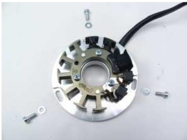
Setzen Sie jetzt die neue Statoreinheit auf den Lichtmaschinenitz des Motors und befestigen Sie diese mit den 3 mitgelieferten Schrauben M5 sowie den passenden Unterlegscheiben.
