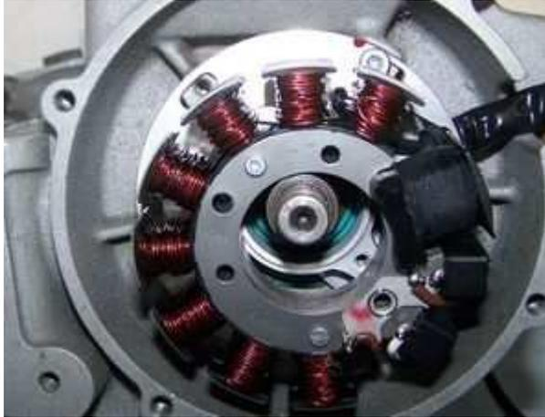
Entfernen Sie die 3 Schrauben, die den neuen Stator auf seiner Grundplatte halten und ziehen Sie ihn etwas von der Platte weg, so daß Sie Zugang zu den Befestigungslöchern darunter erhalten. Achten Sie darauf, die Lackisolierung der Spulendrähte nicht zu beschädigen.
