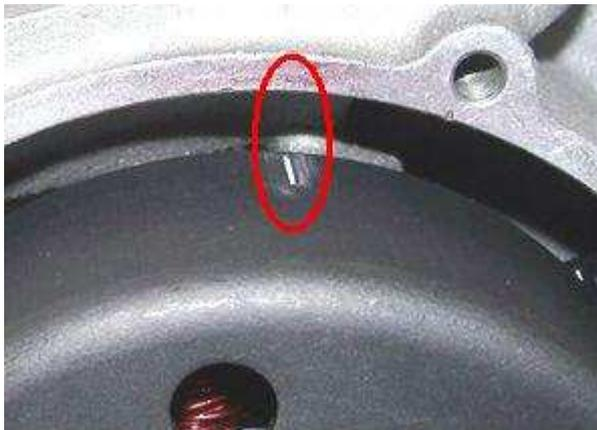
Entfernen Sie die Zündkerze und bringen Sie den Kolben in Zündposition. Den Wert dafür entnehmen Sie bitte Ihrem Handbuch (wenn keine Werte zur Verfügung stehen, probieren Sie es mit 2mm vor OT). Stecken Sie den neuen Rotor dazu relativ lose auf. Sie können damit die Kurbelwelle drehen.
