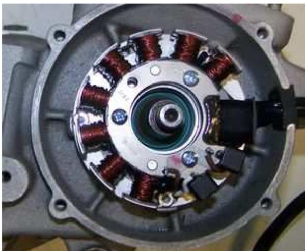
Setzen Sie den Stator wieder auf die nun am Motor verschraubte Grundplatte. Die Spule muss dort recht hart einrasten. Setzt Sie nur weich auf die Platte auf, ist mit großer Sicherheit ein Kabel darunter eingeklemmt! Stellen Sie sicher, daß der Stator gerade auf der Platte sitzt und keine Kabel eingeklemmt sind - ansonsten kommt es zur Zerstörung der Anlage oder zumindest Fehlfunktionen.
