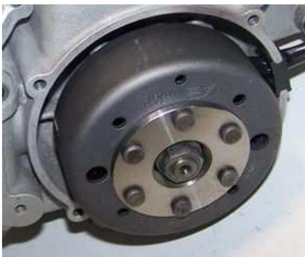
Verschrauben Sie den Rotor mit der originalen Befestigungsmutter.
