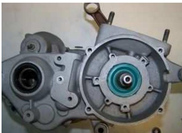
Lösen Sie alle zur alten Lichtmaschine und der Zündspule führenden Kabel und entfernen Sie diese Teile. Sollten sich am Gehäuse irgendwelche Adapter für alternative Lichtmaschinen befinden, bitte auch diese entfernen, bis das Gehäuse so wie hier gezeigt leer ist.
