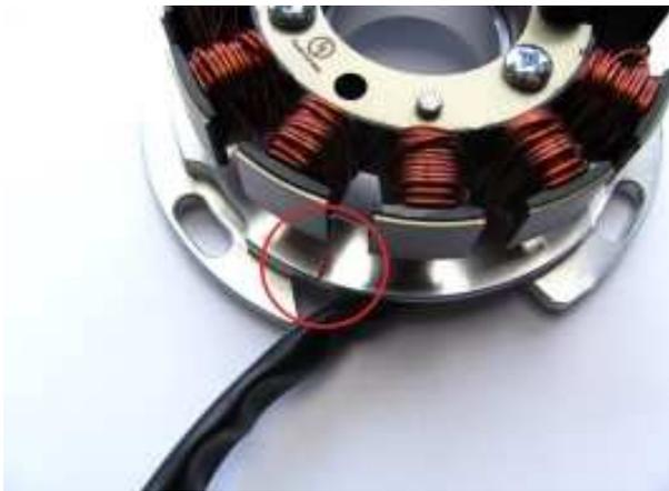
Schauen Sie sich die neue Statoreinheit an. Auf der Grundplatte befindet sich eine kleine rote Zündmarkierung.
