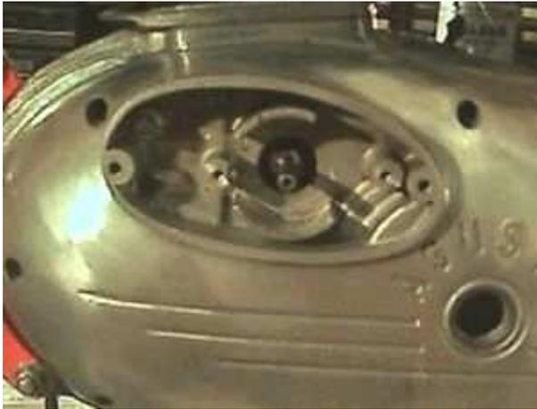
Ziehen Sie die Kabel der alten Zündspule ab und entfernen Sie die Zündspule.
