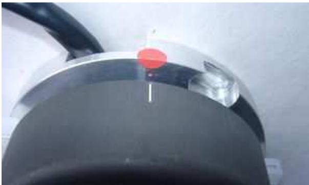
Ist die OT Position gefunden, ziehen Sie den Rotor wieder vorsichtig ab (Dabei nicht die Position der Kurbelwelle ändern!) und setzen ihn so auf, dass die kleine Strichmarkierung des Rotors an der roten Bohrmarkierung der Grundplatte steht.
