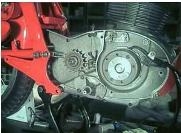
Verschrauben Sie den Rotor sorgfältig. Achten Sie die ganze Zeit darauf, nicht die Kurbelwelle zu bewegen oder den Rotor zu verdrehen, sonst stimmt die Zündung nicht. Schrauben Sie die Zündkerze wieder zurück in die Zylinder.
