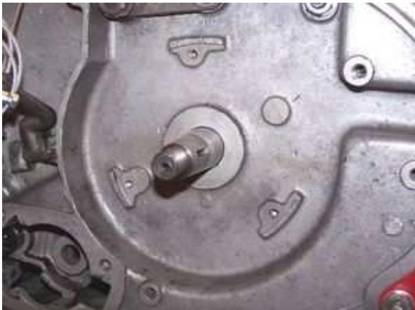
Lösen Sie die 3 Schrauben der alten Statorgrundplatte und entfernen Sie diese.
