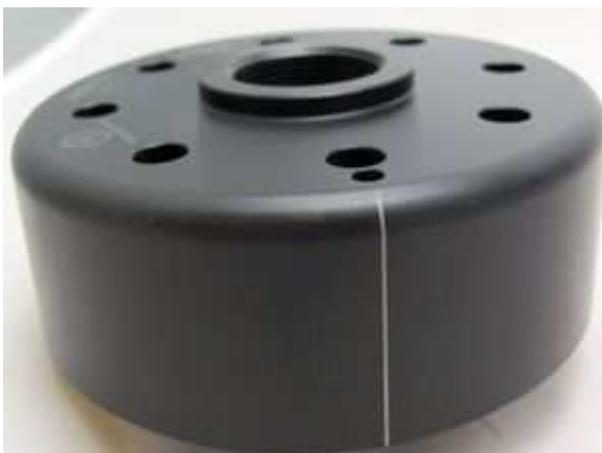
Sehen Sie sich jetzt den Rotor an, auf seinem Außenumfang finden Sie eine eingepresste Marke. Auch das ist eine Zündmarkierung. Die Markierung ist dauerhaft, aber schlecht sichtbar. Es ist daher eine gute Idee sie mit einem Faserstift zu verstärken.
