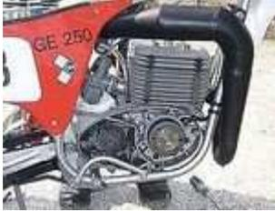
**Lichtmaschine/elektronische Zündung für MZ GE 250 mit original Kleinserienzündung**
