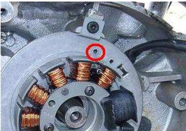
Sehen Sie sich die Grundplatte an. Auf ihr werden Sie neben dem Kabel 2 Bohrungen finden. Die linke davon, hier im Bild rot eingekreist, ist die Markierung für die Zündeneinstellung.
