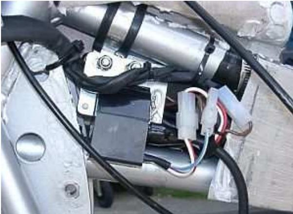
Befestigen Sie nun die Zündspule und den Regler an einer geeigneten Stelle.
