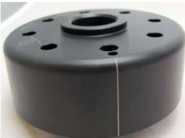
Sehen Sie sich den neuen Rotor an. Auf seinem Umfang werden Sie eine aufgelaserte Linie (ältere Rotoren [eingepresste Linie](#)) sehen. Auch das ist eine Zündmarkierung.
