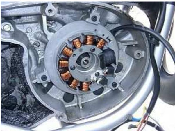
Stecken Sie die neue Statorplatte mit dem dort montierten Spulenkörper in die Lichtmaschinenaufnahme des Kurbelgehäuses. Die Position des Stators ist dabei von der Sache her gleichgültig.
