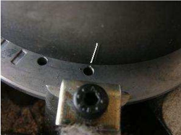
Bei Kurbelwelle in Zündposition, stecken sie nun den Rotor vorsichtig (dabei die Stellung der Kurbelwelle nicht verändern!) so auf die Kurbelwelle, daß die Markierung auf dem Rotor an der Markierung auf der Grundplatte steht wie hier im Bild gezeigt.
