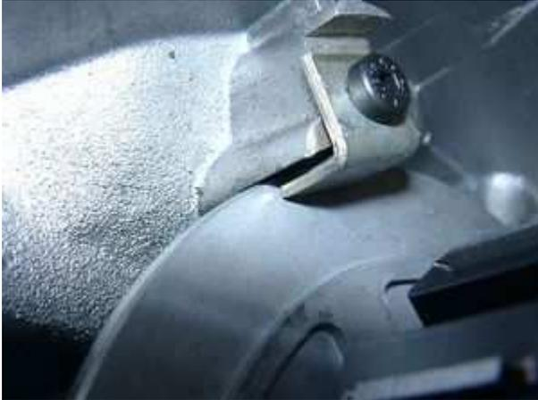
Befestigen Sie die Platte mit den 3 Haltewinkeln. Diese klemmen den Stator nach unten fest.
