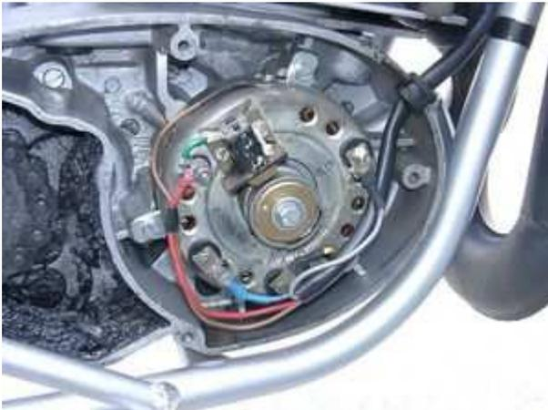
Entfernen Sie die alte Lichtmaschine/Zündung komplett. Entfernen Sie den Kabelstrang der aus dem Motor hochgeht. Dieser Strang teilt sich im Rahmendreieck. Ein Teil geht zum Cockpit (Licht und Ausschalter), ein anderer zum hinteren Teil des Motorrades (Rück- und Stopplicht). Treffen Sie den Kabelbaum daher auf Höhe Rahmendreieck so, daß die Teilstücke zum Scheinwerfer und zum Rücklicht erhalten bleiben.
